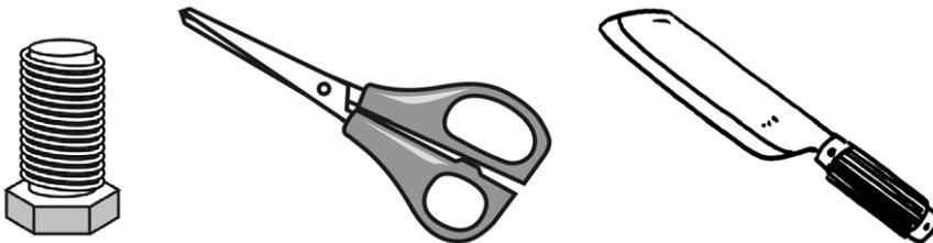
Gambar 9.9 Berbagai alat yang menggunakan prinsip bidang miring.
