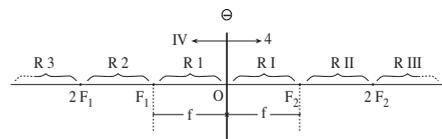
Gambar 17.35 Pembagian ruang pada lensa cekung dan cembung
