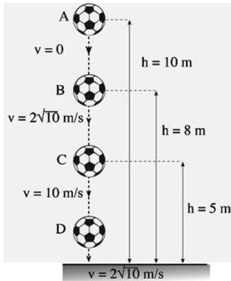
Gambar 12.2 sebuah benda dengan massa 1 kg dijatuhkan bebas dari A kemudian bergerak sehingga sampai di B, di C, dan di D. Adapun data ketinggian dan kelajuan seperti pada gambar di samping. Nilai energi kinetik, energi potensial dan energi mekanik seperti pada tabel berikut.
