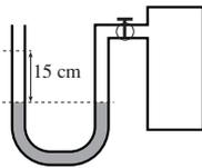
Setelah kran di buka keadaan manometer seperti gambar. Jika tekanan udara luar saat  $15 \text{ cm}$  itu  $74 \text{ cm Hg}$ , berapa tekanan gas dalam tangki?
