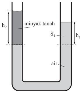
Tinggi minyak 10 cm. Selisih tinggi permukaan air 8 cm.  $\rho_{\text{air}} = 1 \text{ g/cm}^3$
