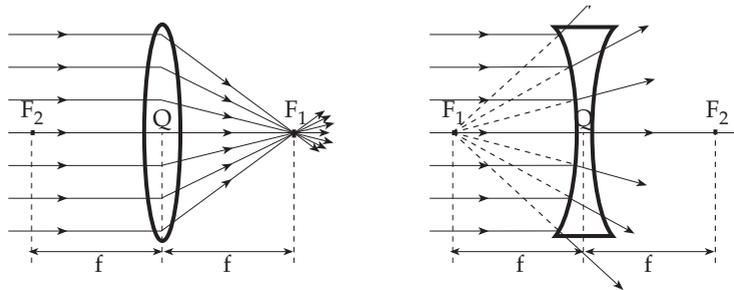
Gambar 17.28 Titik fokus lensa cembung dan cekung
