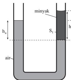
Bila ke dalam pipa-U diisi dengan zat cair tidak sejenis dan tidak saling melarutkan, misalnya air dan minyak maka permukaan minyak akan lebih tinggi dari pada permukaan air.
