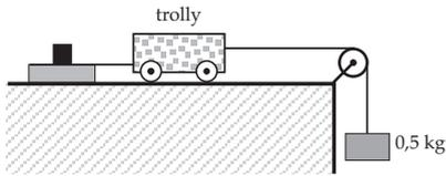
Gambar di samping adalah perlengkapan percobaan hukum II Newton. Jika massa trolley = 0,5 kg maka grafik hubungan kecepatan terhadap 0,5 kg waktu yang terekam pada pita ticker timer yang benar adalah ....
