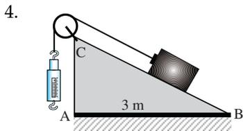
Gambar di samping adalah sebuah benda dengan berat 100 N diletakkan pada bidang miring licin ABC dan diikat tali melalui katrol serta pada ujung tali dihubungkan dengan neraca pegas. Jika panjang  $AB = 8 \text{ m}$  dan  $BC = 10 \text{ m}$ , maka berapakah angka yang ditunjukkan oleh neraca pegas?
