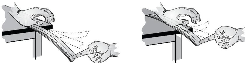
Gambar 16.6 Percobaan sederhana untuk mengetahui batas pendengaran
