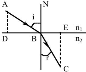
Gambar tersebut menggambarkan jalannya sinar yang datang dari medium I ke medium II. Panjang sinar datang  $AB =$  panjang sinar bias  $BC$ .  $DB$  dan  $BE$  adalah proyeksi sinar datang dan sinar bias pada bidang batas medium I dan medium II.
