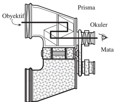
Pembalik untuk teropong prisma menggunakan prisma yang fungsinya sama dengan lensa pembalik. Oleh karena itu, teropong prisma lebih pendek seperti gambar di samping ini.
