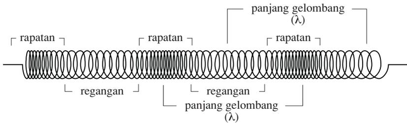
Gambar 15.12 Rapatan dan regangan pada gelombang longitudinal
