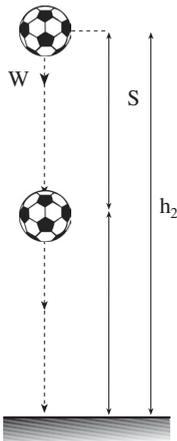
Gambar 12.7 sebuah benda dengan berat  $w$  dijatuhkan bebas dari ketinggian  $h_1$  dari tanah, sehingga setelah menempuh jarak  $s$  ketinggian benda menjadi  $h_2$ . Usaha yang dilakukan oleh gaya berat  $w$  selama perpindahan sejauh  $s$  dinyatakan dengan persamaan :
