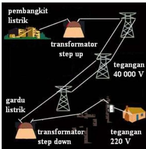
Gambar 4.26 Transformator dan aliran listrik
