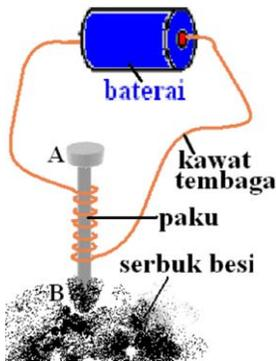
**Gambar 4.8** membuat magnet dengan aliran listrik
