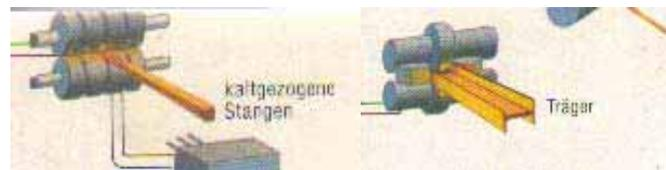
Gambar 2 15. Mesin pengerollan (*rolling*)
