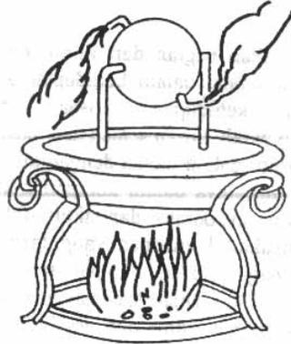
**Gambar 2 19. Mesin konversi dari panas ke uap**
