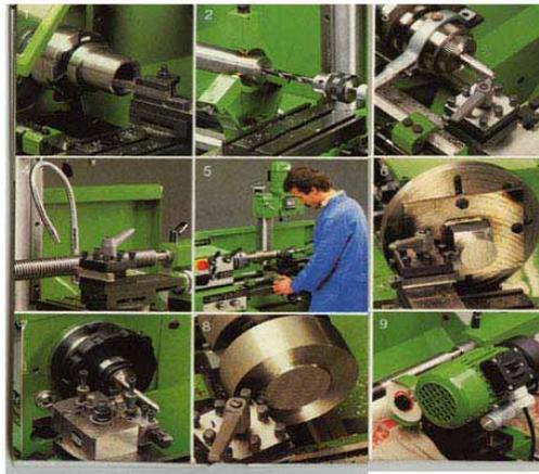
**Gambar 6 16. Beberapa contoh proses bubut dengan cara pengekaman/pemegangan benda kerja yang berbeda-beda.**
