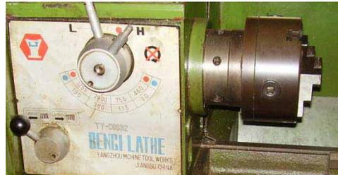
**Gambar 1 22. *Spindle* mesin bubut**
