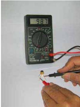
Gambar 3.9: Mengukur resistansi junction sebuah transistor npn mempergunakan multimeter. Bias arah maju pada basis-emiter, harus menunjukkan resistansi rendah. Biasanya kurang dari 1 k ohm.
