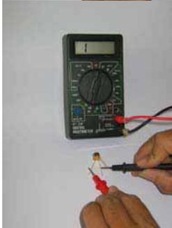
Gambar 3.12: Bias arah balik pada kolektor basis harus menunjukkan resistansi tinggi (lebih besar dari 100 k ohm).
