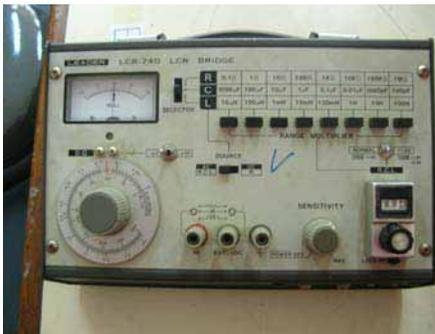
Gambar 3.15: Kapasitansi / Induktansi Meter.
