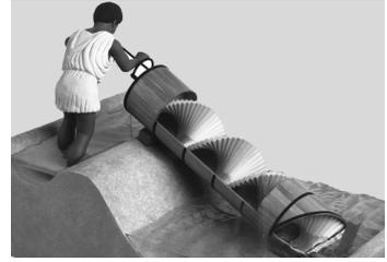
Penaik air ini adalah alat yang diciptakan oleh Archimedes untuk menaikkan air dari sungai atau kanal. Prinsip dasar dari alat ini adalah bidang miring yang disusun menjadi pilinan (heliks). Apabila pegangan di ujung tabung di putar, pilinan tersebut akan mengangkat air ke atas.
