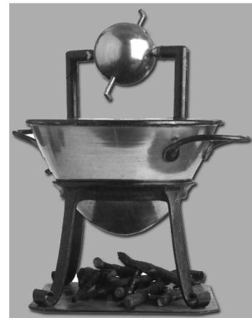
Hero atau Heron membuat mesin uap pertama yang disebut aeolipile. Mesin ini terdiri atas sebuah pemanas yang terletak di bawah suatu kuali dan memiliki dua lubang angin. Uap yang dialirkan ke dalam kuali akan keluar dari lubang angin sehingga akan memutar kincir. Aeolipile tidak memiliki fungsi praktis.
