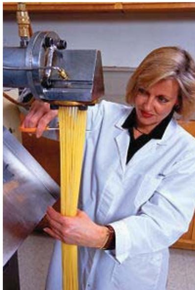
Gambar 11.11 Pasta yang dibuat dengan mesin ekstrusi
