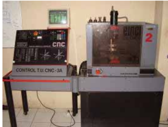
Gambar 61. Mesin Frais CNC TU 3A EMCO
