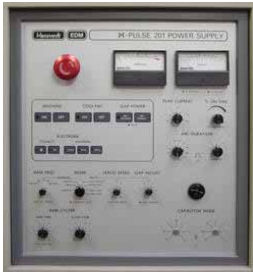
Gambar 66. Kontrol Panel Mesin EDM
