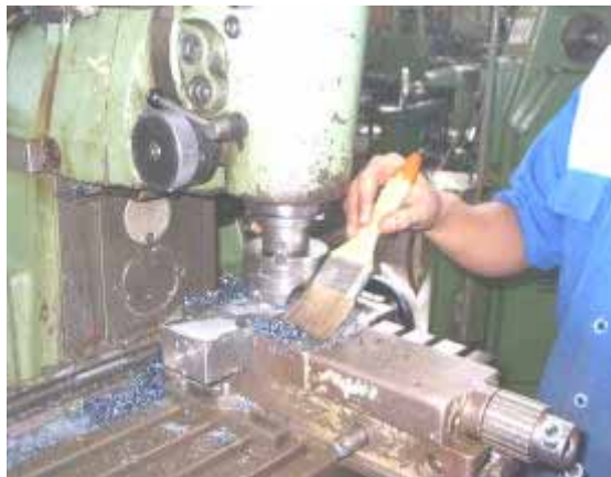
Gambar 167. Membersihkan chip/beram pada saat putaran mesin harus berhenti
