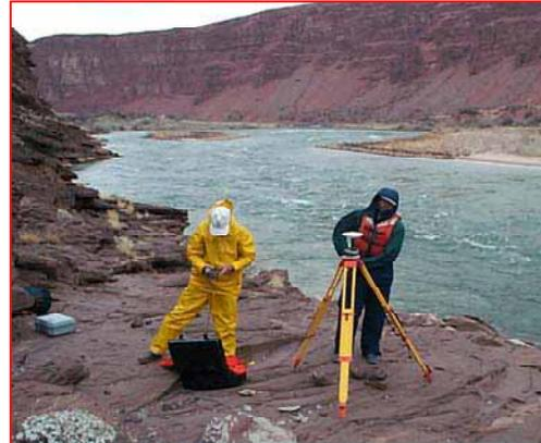
Gambar 191. Pemasangan Theodolite di titik P
