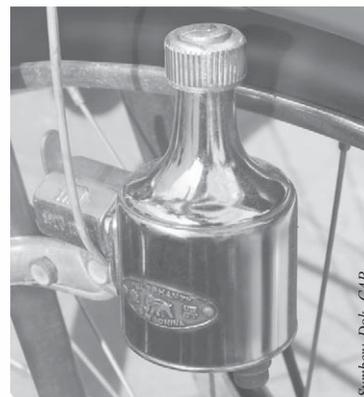
Gambar 6.4 Dinamo sepeda menggunakan prinsip kerja generator
