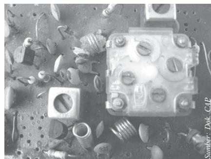
**Gambar 6.12** Rangkaian radio penerima yang memanfaatkan rangkaian RLC sebagai penala (*tuner*)
