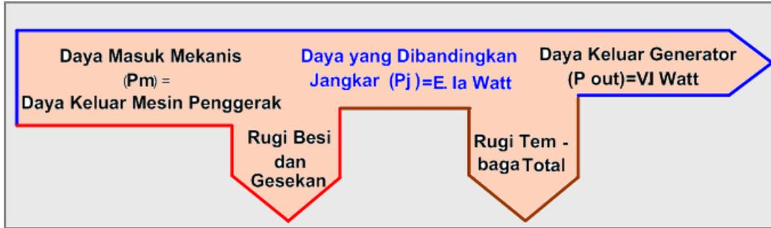
Gambar 5.79 Diagram Aliran Daya pada Generator Arus Searah
