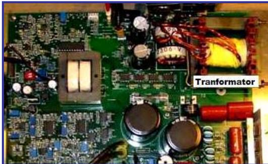
Gambar 5.10 Transformator pada Peralatan Elektronik
