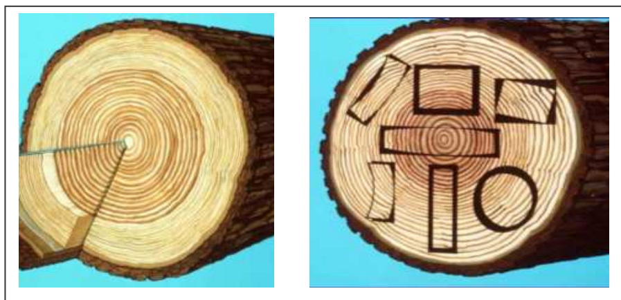
Gambar 8.4. Penyusutan kayu saat proses pengeringan
