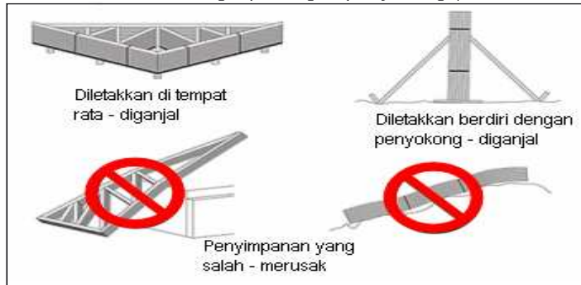
Gambar 8.36: Cara penyimpanan struktur rangka fabrikasi
