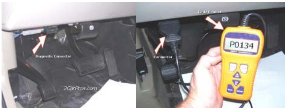
Gambar 11-35. Pemasangan alat uji
