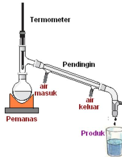
Gambar15.7. Alat destilasi sederhana
