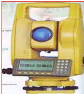
Gambar 390. Pesawat theodolite EDM
