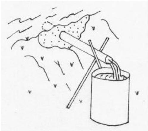
menampung aliran dan saat itu adalah waktu untuk mengisi ember. Ukuran ember untuk menampung air berkisar 100-200 liter (setengah atau memenuhi tong minyak kosong). Bagi volume ember (dalam liter) dengan waktu pemenuhan (dalam detik) untuk memperoleh aliran rata-rata dalam liter per detik.
