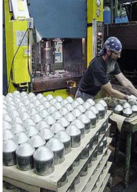
Gambar. 9.88. Produksi dari proses pressing mangkuk. dalam jumlah besar.
