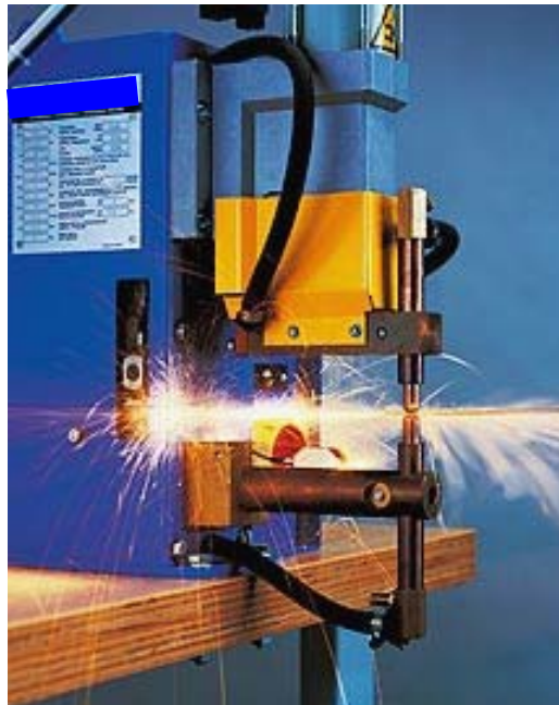
Gambar 7.34 Proses Las Resistansi
