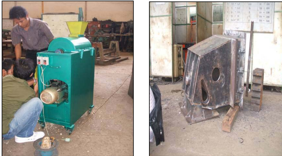
Gambar 9.1 Hasil Produk Pelat Tipis dan Pelat Tebal untuk Konstruksi alat pengolahan Hasil Pertanian dan Turbin air Skala Kecil
