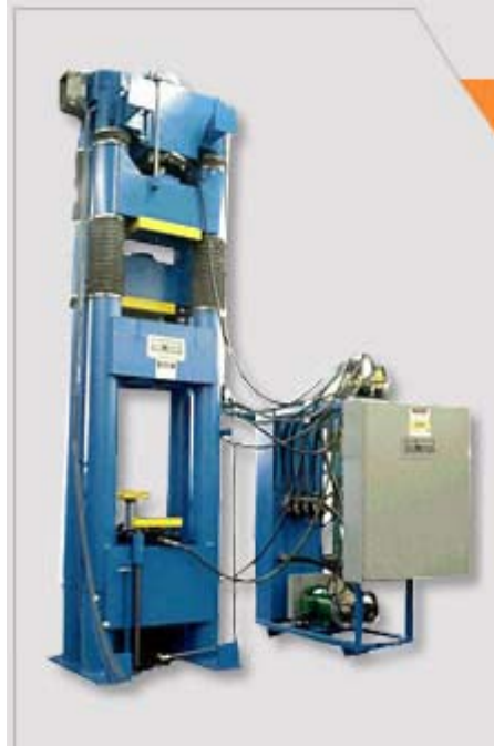
Gambar.9.87 Mesin Squeezing sistem hidrolik
