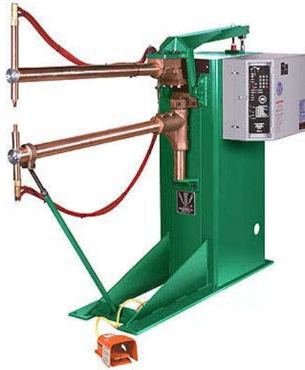
Gambar 7.30. Las resistansi titik dengan penggerak tuas tangan
