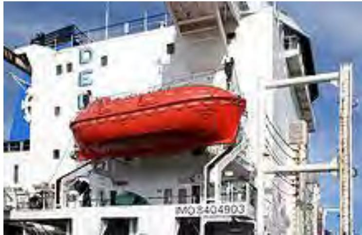
**Gambar 62. Penempatan sekoci di kapal**
