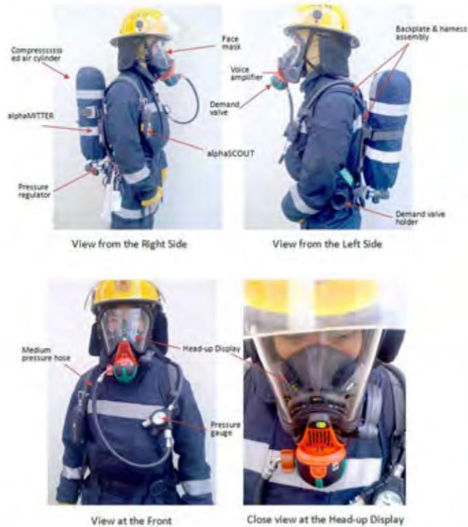
**Gambar 99. Bagian dan cara menggunakan breathing apparatus**
