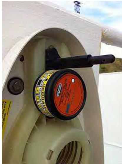
**Gambar 92. Hydrostatic Release System pada EPIRB**
