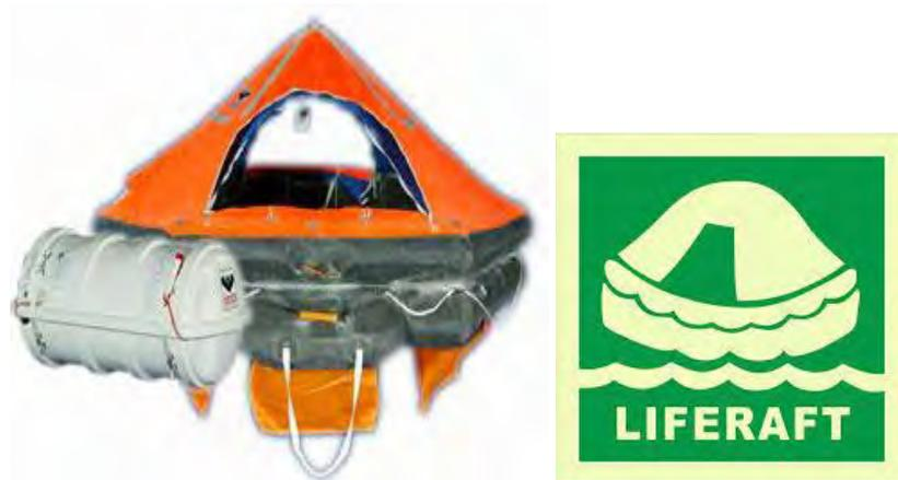
**Gambar 63. Liferaft dan lambang liferaft**
