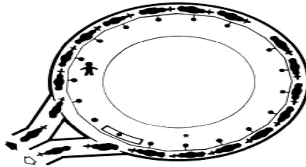
**Gambar 22. Layout Mesin Perah Tipe Rotary Tandem**
