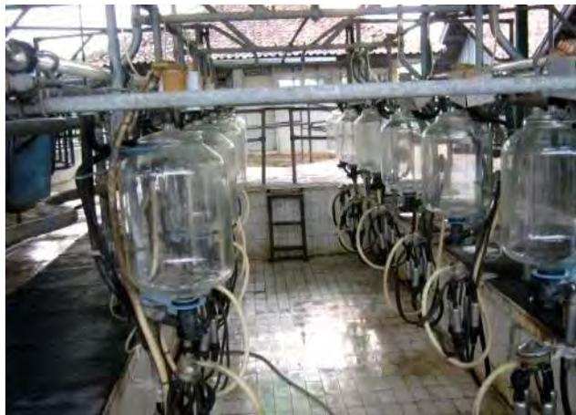
**Gambar 19. Mesin Perah Tipe Herringbone dengan Tabung Individu.**
