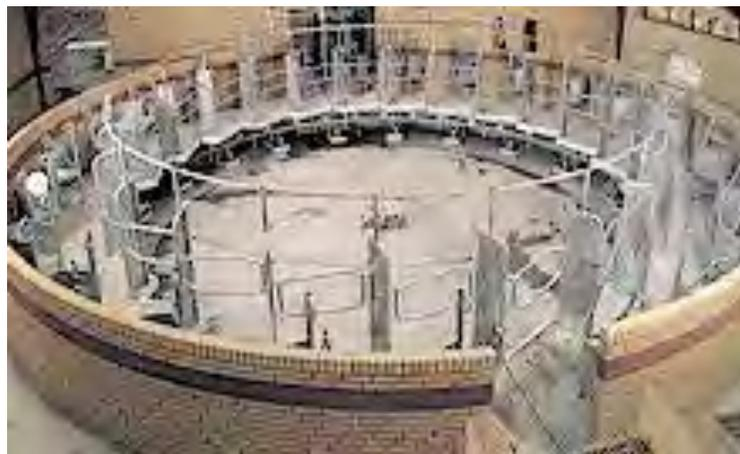
**Gambar 21. Layout Mesin Perah Tipe Rotaryy Abreast**
