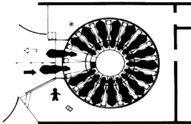
**Gambar 20. Layout Mesin Perah Tipe Rotaryy Abreast**
