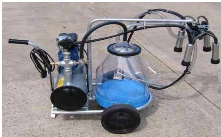
**Gambar 23. Mesin Perah Portable**
