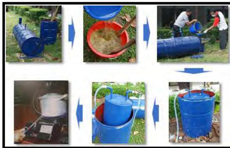
Gambar 16. Alur proses pembuatan gasbio
