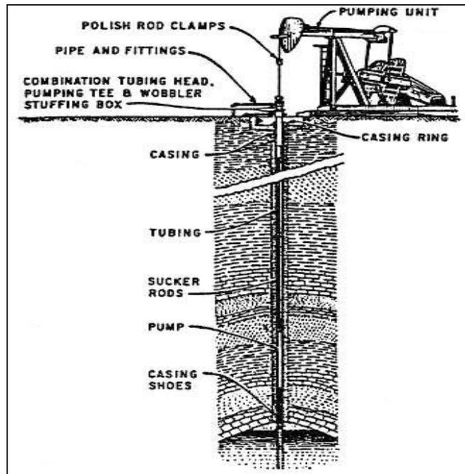
Gambar 8.8. Sistem Pemompaan *Beam*
