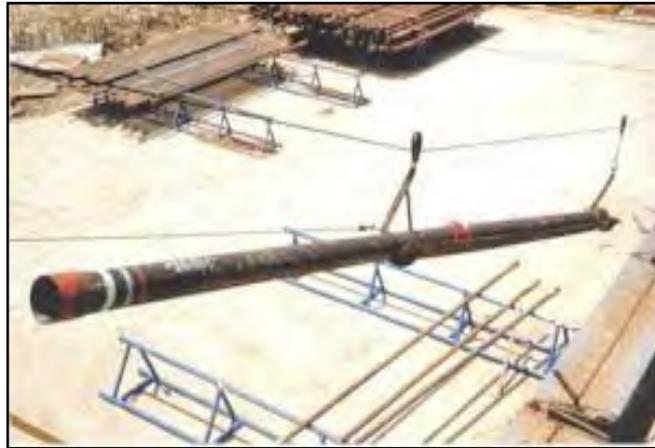
Gambar 5.8. *Lifting Casing*
