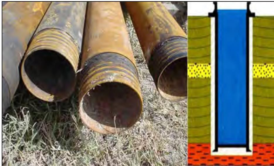
Gambar 5.2. *Conductor Casing*
