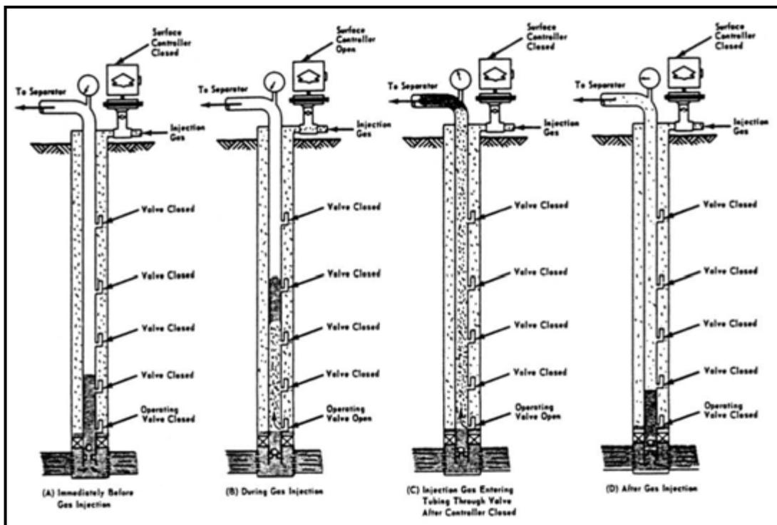
Gambar 8.7. Siklus Operasi Aliran Intermittent untuk Instalasi-Tertutup Konvensional
