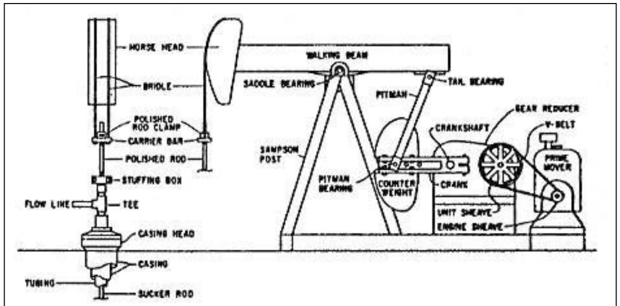
Gambar 8.9. Peralatan Permukaan Suatu Instalasi Pemompaan *Beam*
