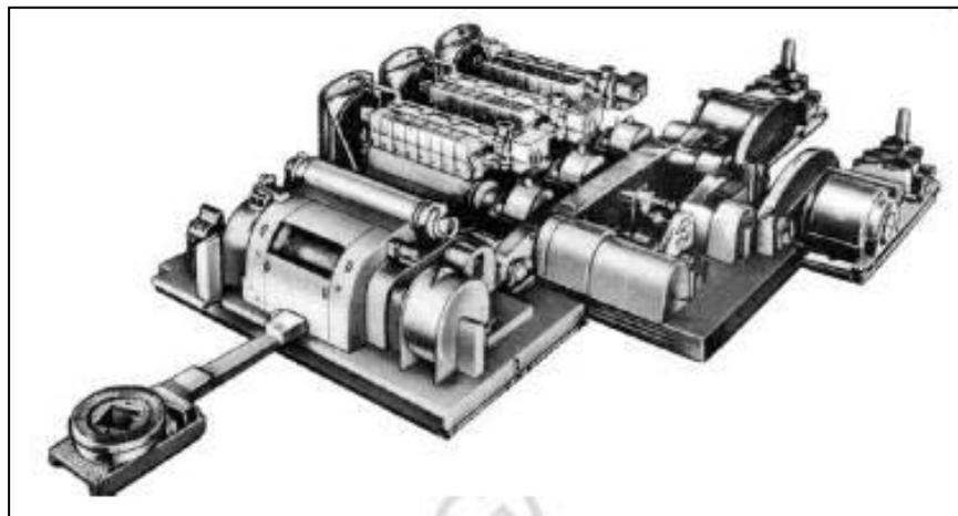
Gambar 4.13. *Rotary table* dengan penggerak *Drawwork*
