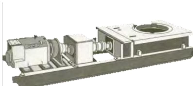
Gambar 4.14. *Rotary table* dengan penggerak *Prime mover*
