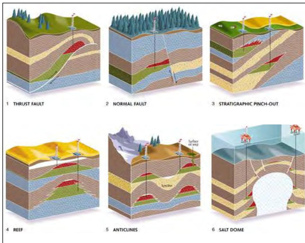
Gambar 2.1. Perangkap Reservoir
