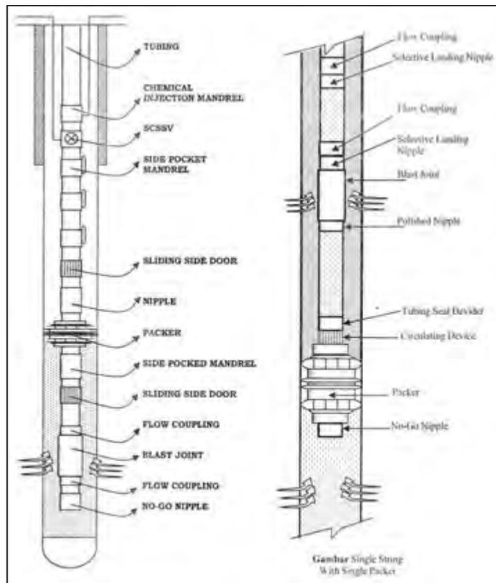
Gambar 8.6 Instalasi Bawah permukaan sumur sembur alam
