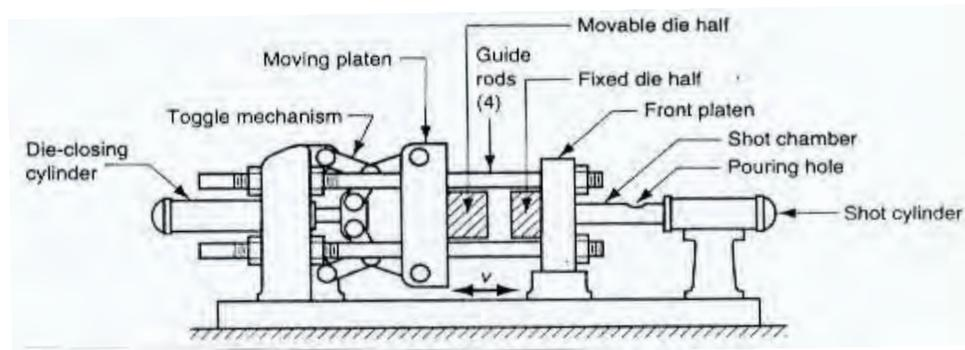
**Gambar 83. Konfigurasi mesin pengecoran cetak tekan ruang dingin (*cold chamber*) (sumber : google.com)**
