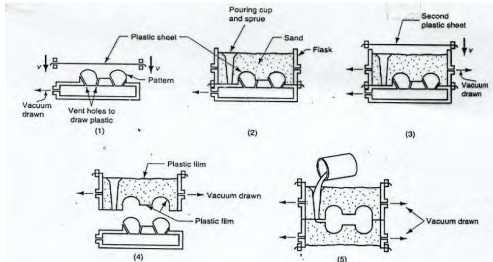
**Gambar 78. Tahapan pembuatan cetakan vakum**
