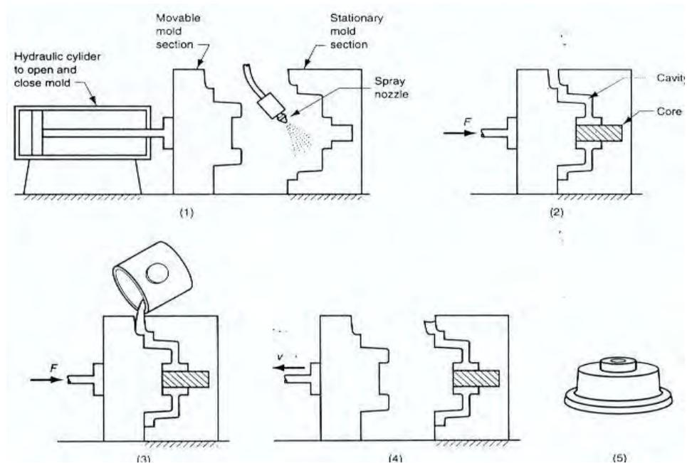
**Gambar 81. Tahapan dalam pengecoran dengan cetakan permanen**
