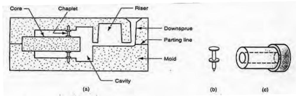
**Gambar 76. (a) Inti disangga dengan chaplet, (b) chaplet, (c) hasil coran dengan lubang pada bagian dalamnya (sumber : google.com)**
