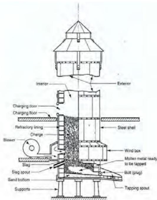
**Gambar 89. Kupola yang digunakan untuk peleburan besi tuang**
