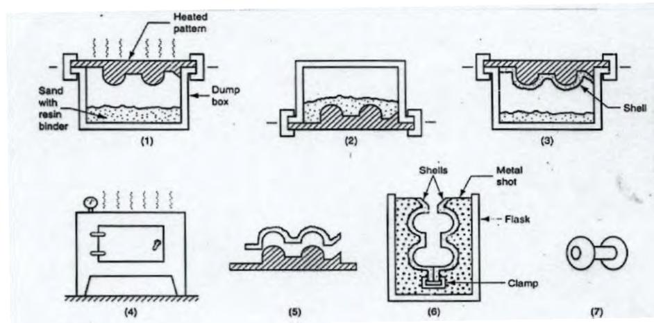
**Gambar 77. Tahapan pembuatan cetakan kulit
