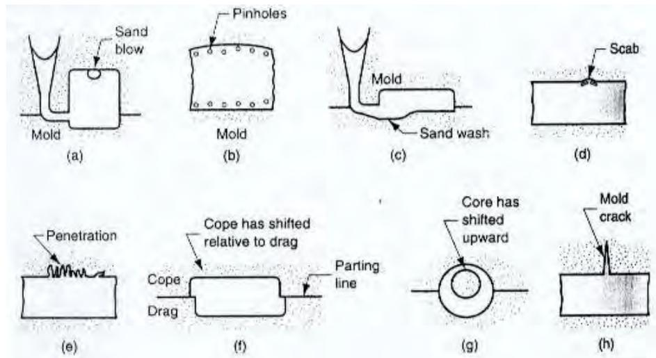
**Gambar 94. Beberapa jenis cacat dalam pengecoran dengan cetakan pasir (sumber : google.com)**
