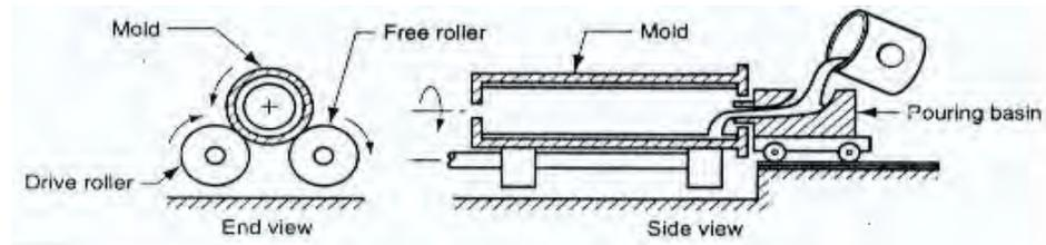
**Gambar 86. Proses pengecoran sentrifugal sejati
