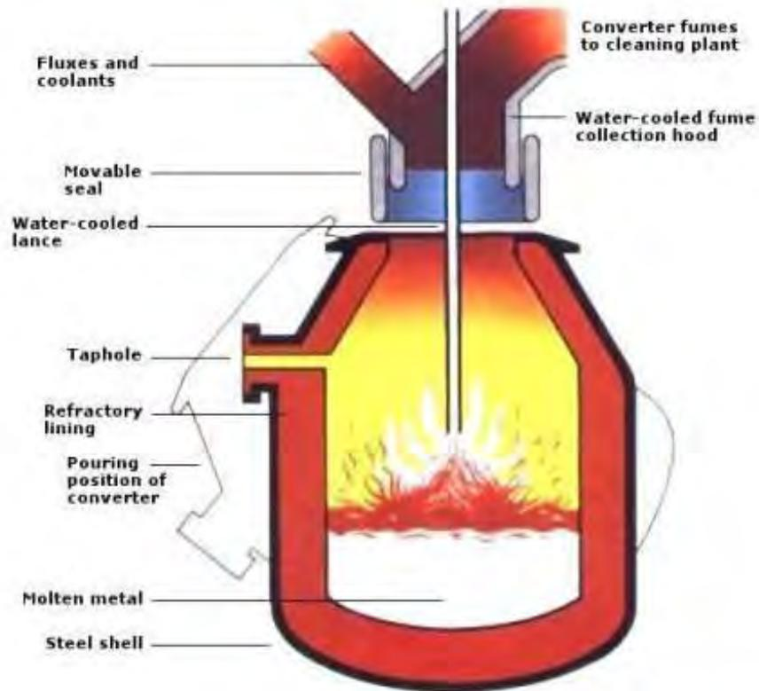
**Gambar 58. Reaktor oksigen, pada proses Bessemer
