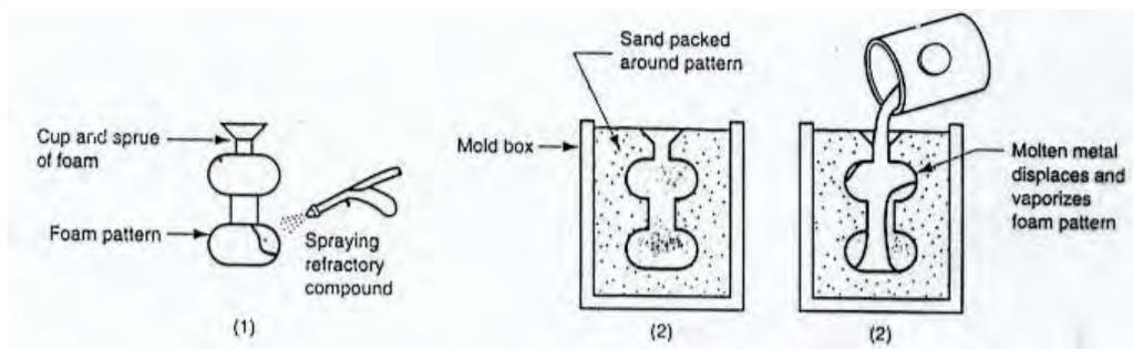
**Gambar 79. Tahapan proses pengecoran polisteren**
