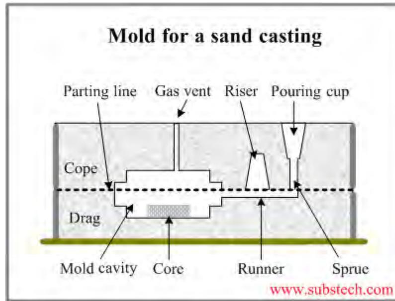
**Gambar 73. Cetakan pasir (sumber : substech.com)**
