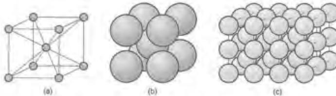
**Gambar 19. Struktur *Body Centered Cubic* (BCC): (a) unit sel, dengan atom sebagai titik acuan sistem aksis tiga dimensi; (b) model unit sel dengan atom yang berdekatan; dan (c) pola berulang dari struktur BCC. (sumber : google.com)**
