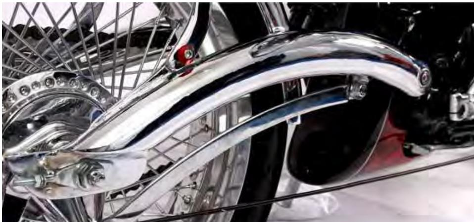
**Gambar 103. Rangka motor dilapis krom untuk mencegah karat**
