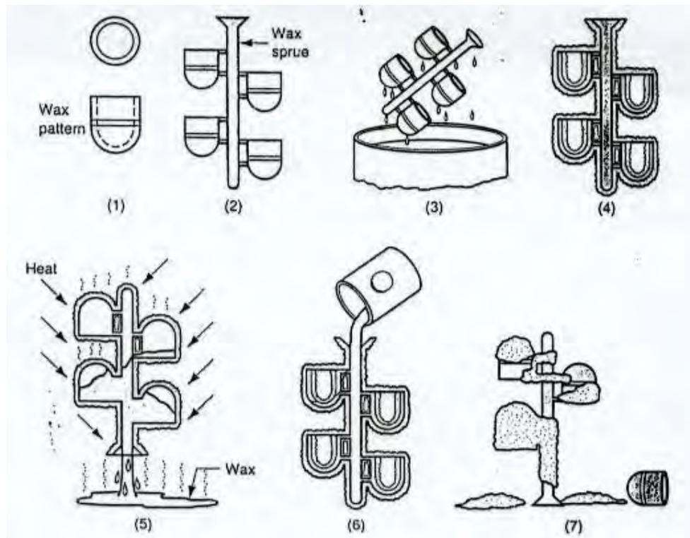
**Gambar 80. Tahapan proses pengecoran presisi**
