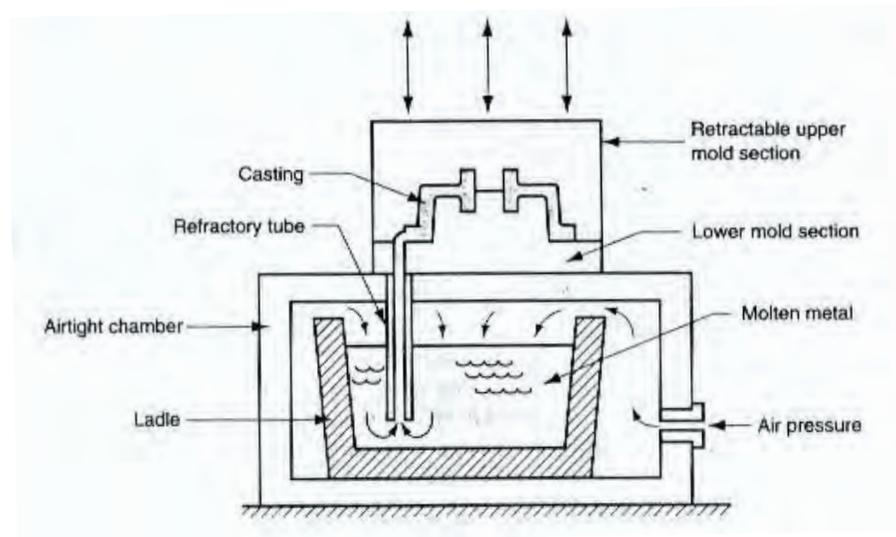
**Gambar 82. Pengecoran dengan cetakan bertekanan rendah**
