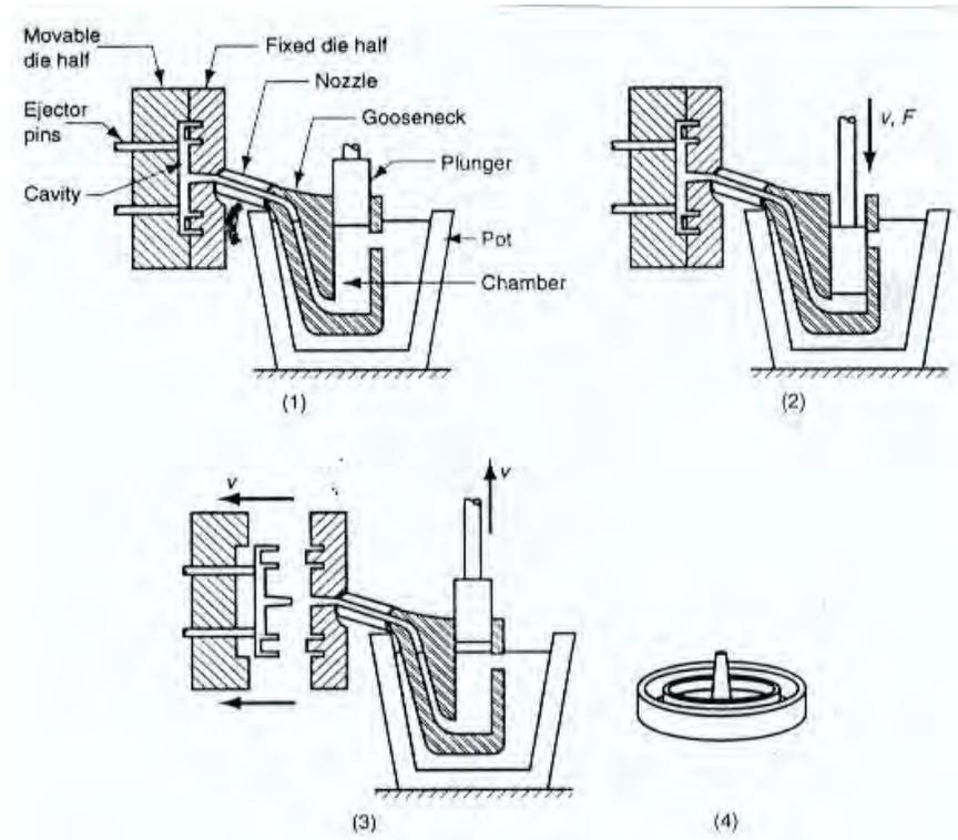
**Gambar 84. Proses pengecoran cetak tekan ruang panas**
