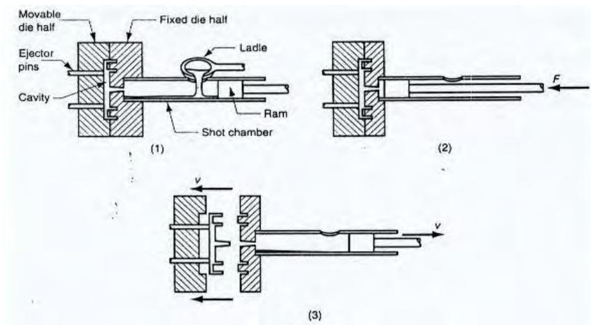
**Gambar 85. Proses pengecoran cetak tekan ruang dingin**
