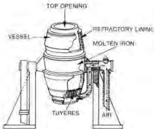
**Gambar 56. Komponen reaktor bessemer**
