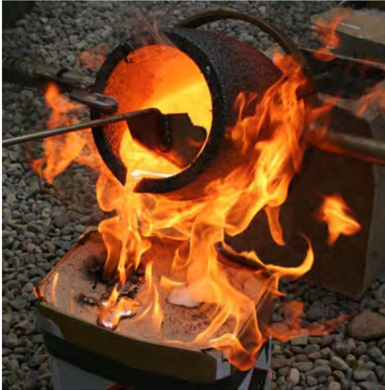
**Gambar 52. Proses penuangan logam cair (sumber : google.com)**
