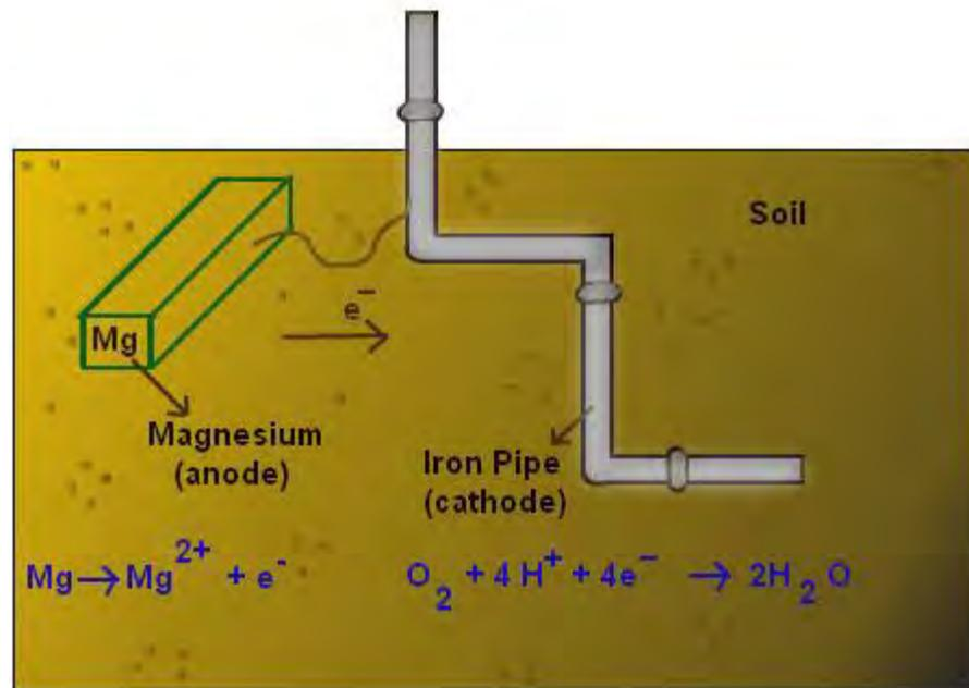
**Gambar 104. Penggunaan magnesium pada instalasi pipa air**
