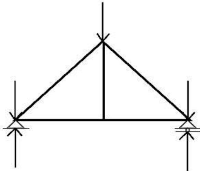
Gambar 89. Konstruksi Rangka Batang Statis Tertentu
