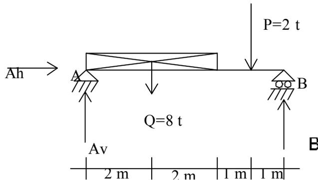
Untuk menghitung reaksi tumpuan maka muatan merata  $q = 2t/m$  sepanjang 4m diganti dengan sebuah muatan terpusat  $Q$ .  $Q=q.l=2t/m.4m=8t$ .
