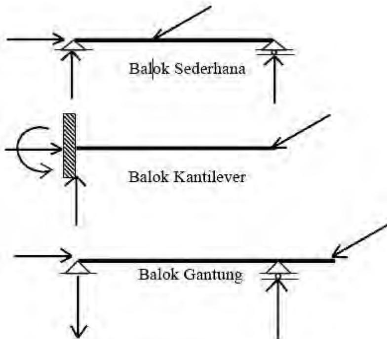
Gambar 87. Balok-Balok Statis Tertentu
