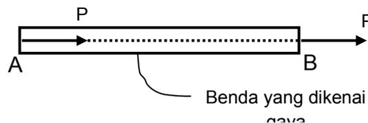
Gambar 12. Gaya  $P$  yang bertitik tangkap di  $A$  dipindahkan di  $B$  dalam garis kerja yang sama
