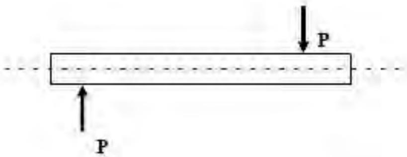
Gambar 94. Konsep SFD pada struktur balok
