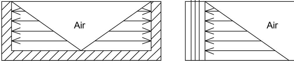
Tekanan air pada dinding bak atau pada pintu air tidak terbagi rata (merupakan tekanan segitiga) yang dimulai dari bagian atas kecil tak terhingga dan semakin ke bawah semakin besar.
