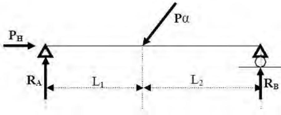
Gambar 90. Konstruksi dengan tumpuan sederhana (sendi rol)
