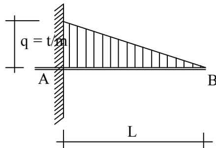
Untuk menghitung reaksi tumpuan maka muatan terbagi tidak merata sepanjang  $l$  diganti dengan sebuah muatan terpusat  $Q$ . Besar  $Q=1/2 q.l$ .
