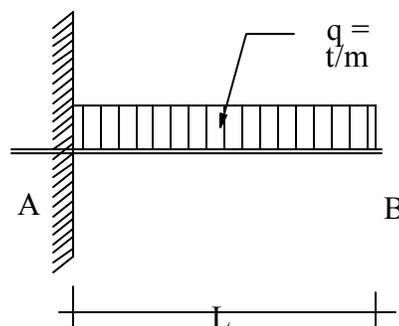
Untuk menghitung reaksi tumpuan, maka muatan merata  $q$  t/m sepanjang  $l$  diganti dengan sebuah muatan terpusat  $Q$ . Besar  $Q = q \cdot l$ . Untuk memudahkan dalam
