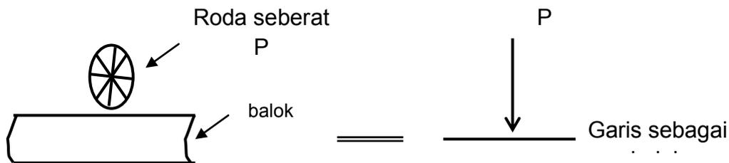
Gambar 65 tekanan pada kereta api pada relnya atau tekanan ban mobil jalan.
