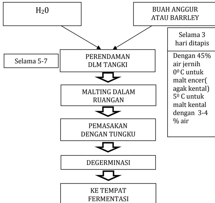
**Gambar 37. Proses Malting pada Pembuatan Bir (Anonim, 2006)**
