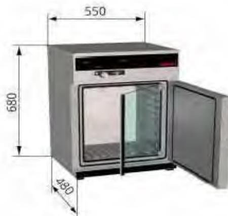
**Gambar 22. Inkubator**
