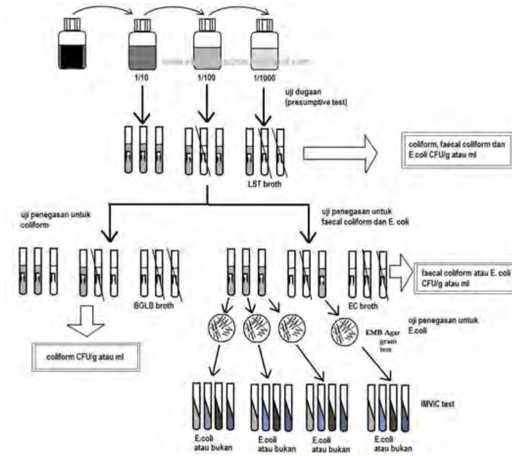
**Gambar 21. Tahapan Uji Coliform dengan seri pengenceran 3 tabung**
