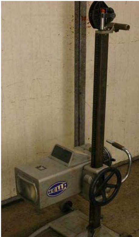
Gambar 3.19. Penyetel Lampu Kepala (*Headlamps Adjustment*)
