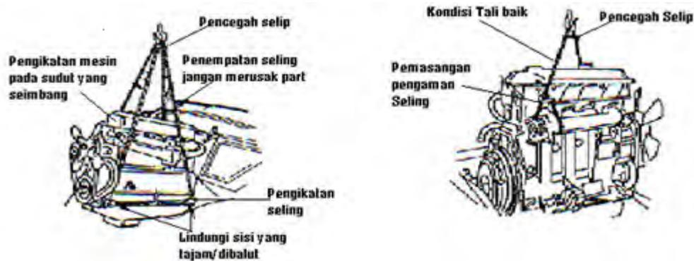
Gambar 3.14. Pemasangan tali atau seling pada engine.
