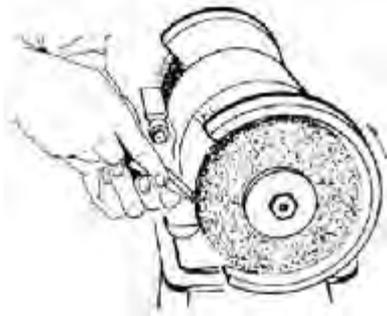
Gambar 2.35. Metode Memegang Tool pada Grinding Wheel
