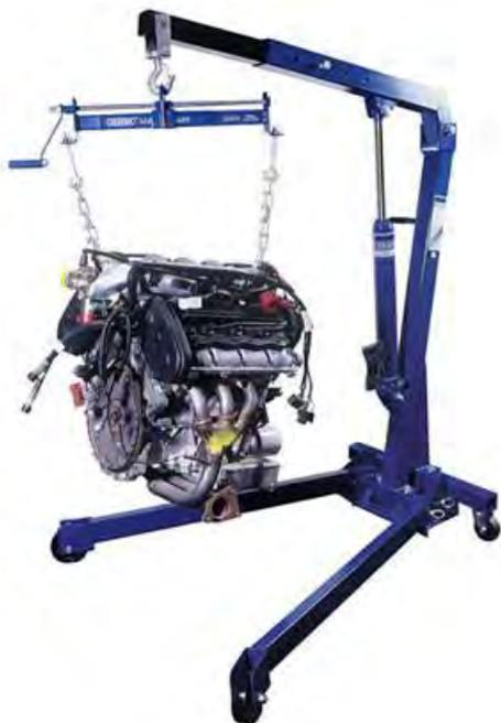
Gambar 3.18. Pengangkatan engine dengan Kran rantai
