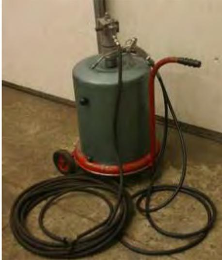
Gambar 3.22. Pompa Pengisi Grease (*Grease Gun Filler pump*)
