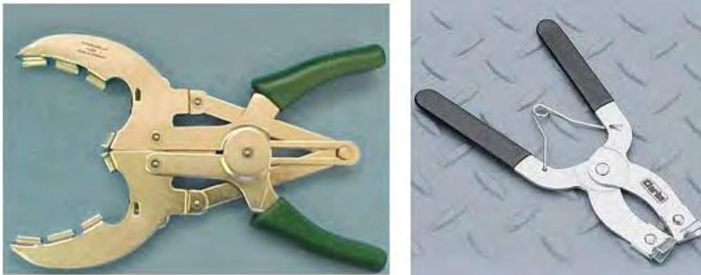
Gambar 4.8. Tang Ring Torak (*Piston Ring Plier*)
