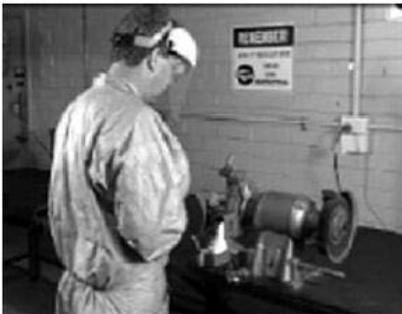
Gambar 2.37. *Persiapan Menggunakan Bench Grinder*
