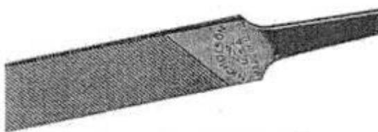
Gambar 1.52. Kikir rata tunggal (*Single Cut Mill File*)**Kikir Rata Tunggal (*Single Cut Mill File*)**
