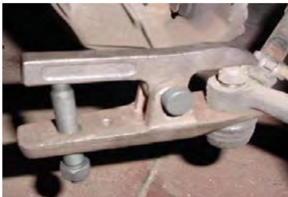
Gambar 4.19. Penggunaan *Traker Ball Joint (Ball Joint Seperator)*
