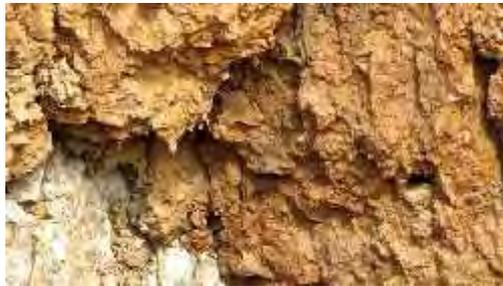
Gambar 1.27. Struktur Tanah Gumpal bersudut
