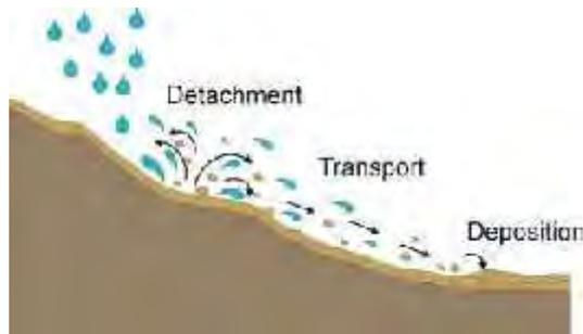
Gambar 3.2 Tahapan Proses Erosi
