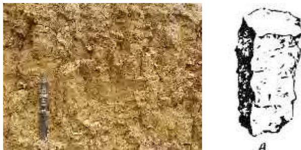
Gambar1.25. Struktur tanah prismatic
