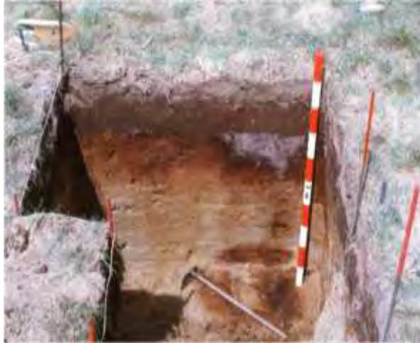
Gambar 1.2. Lubang pengamatan profil tanah
