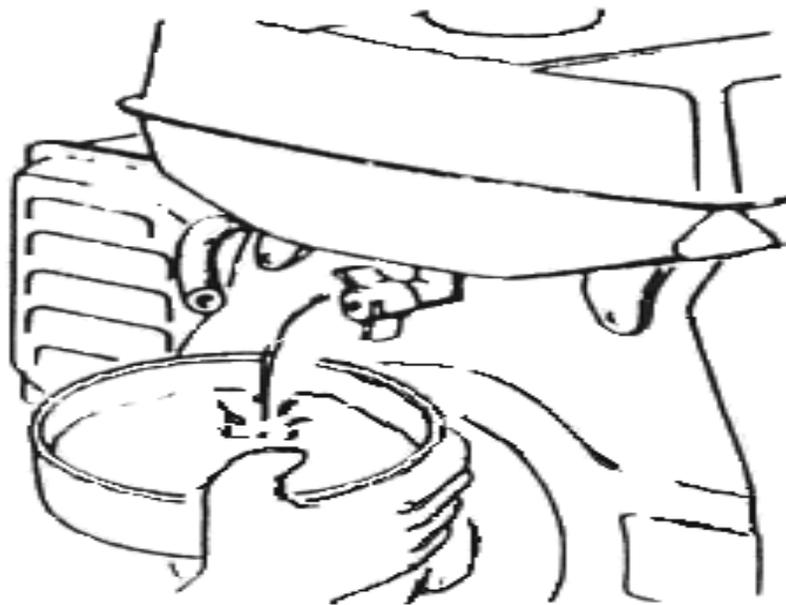
4. Buka saringan bahan bakar (*fuel filter*), seperti gambar di bawah dan bersihkan elemen filter dari kotoran dan air.
