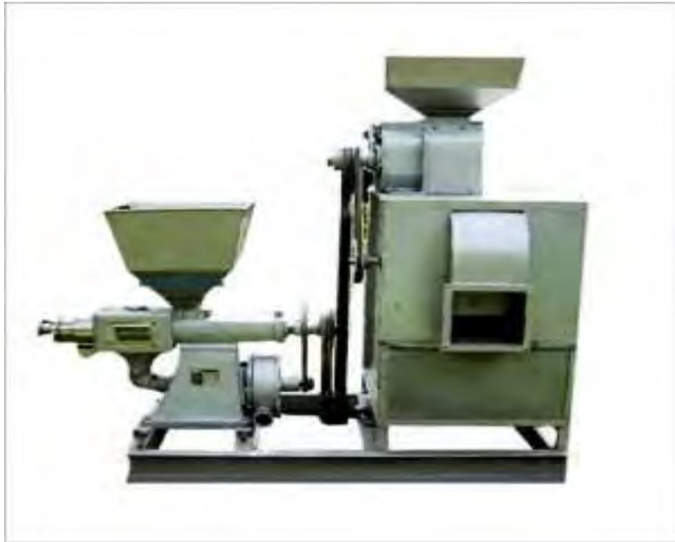
Gambar 55. Penggiling padi (*huller*)
