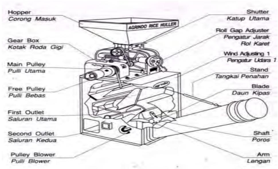
Gambar 56. Mesin pemecah gabah (Sumber: PT. Agrindo)
