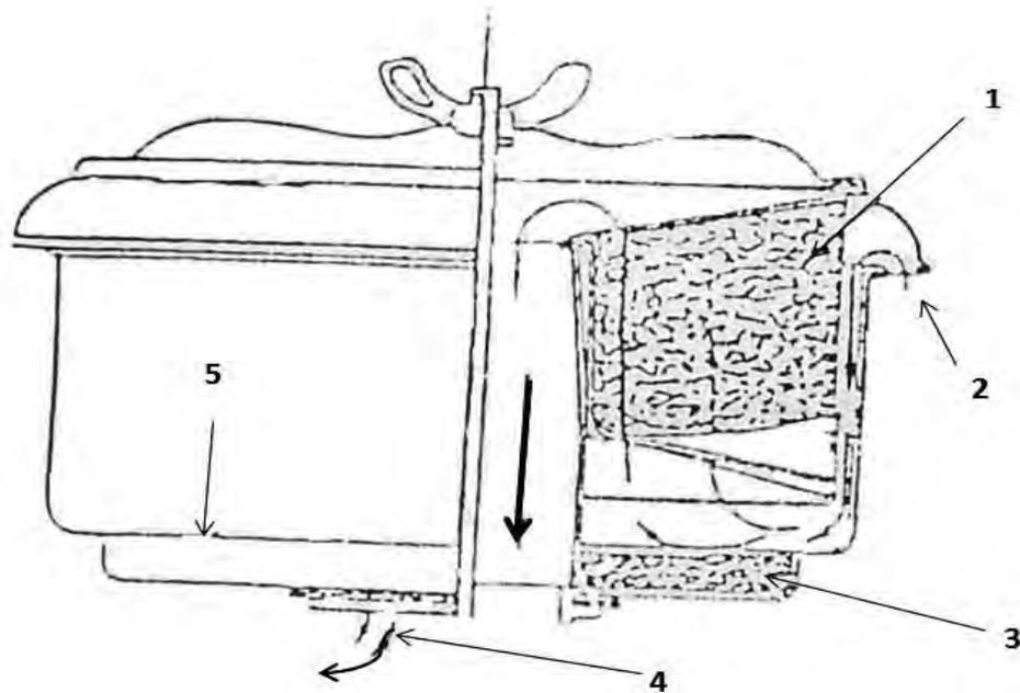
**Gambar 24. Penyaring udara tipe basah jenis bak beroli**
