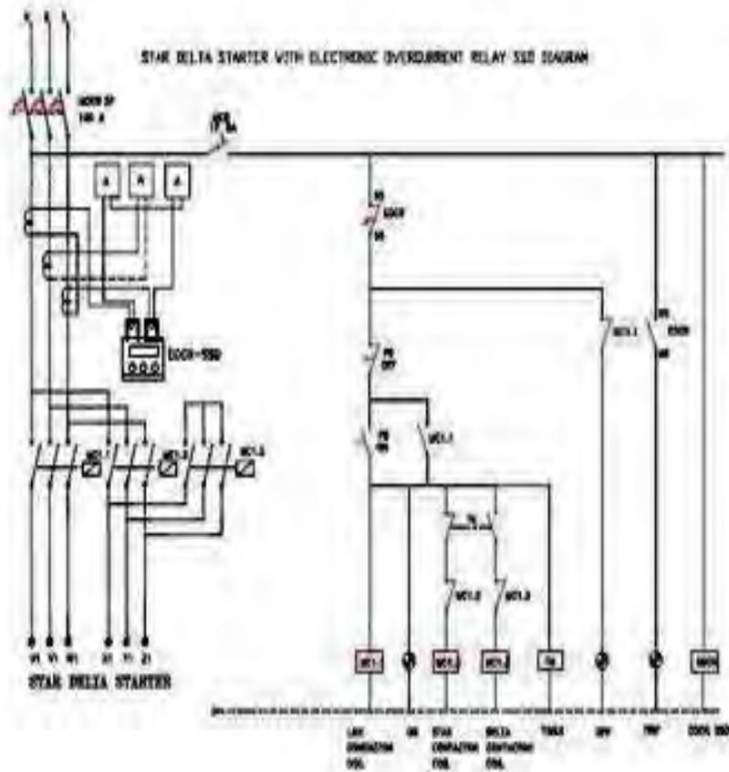
**Gambar 36. Rangkaian System Kendali Elektromagnetik Pada Motor Induksi 3 Fasa Hubungan Bintang Segitiga**
