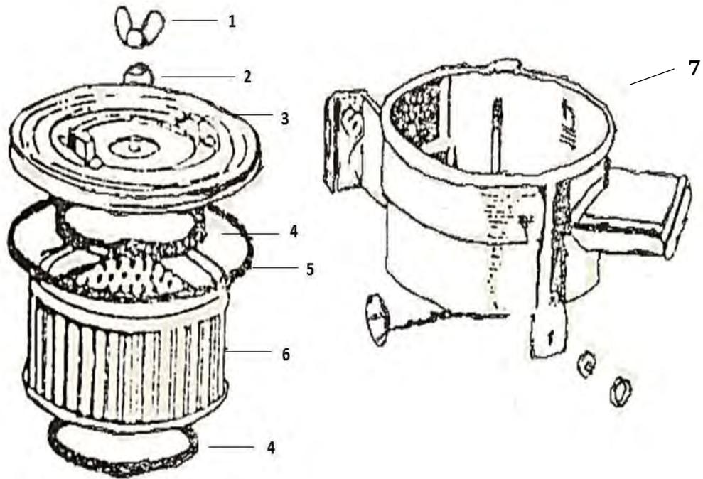
**Gambar 22. Penyaring udara tipe kering dengan elemen kertas**
