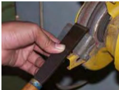
(Gambar 3-16. Mengasah pahat lurus menggunakan mesin gerinda)
