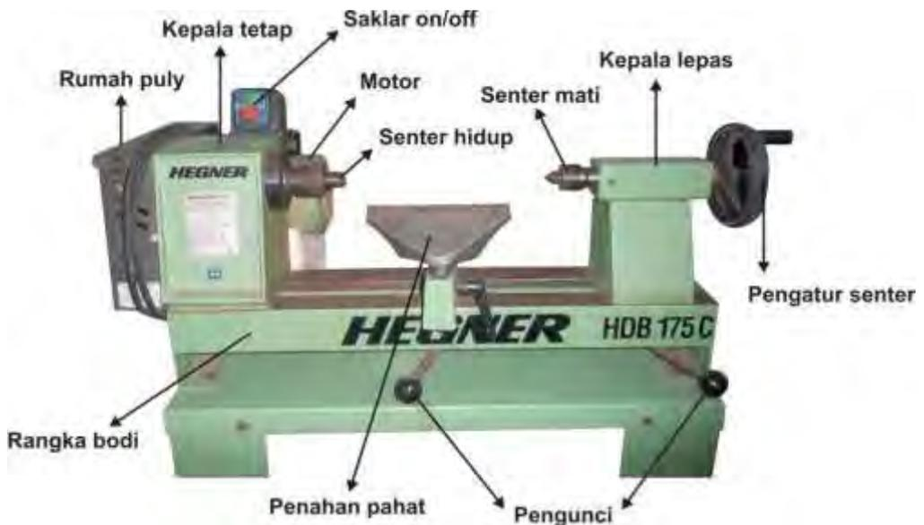
(Gambar 1-8. bagian-bagian mesin bubut)
