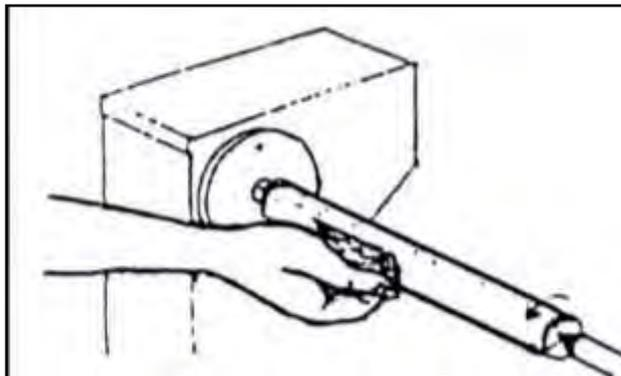
(Gambar 4-7. Penghalusan menggunakan ampelas)
