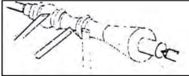
(Gambar 4-8. Pembentukan cembung, cekung, dan alur)
