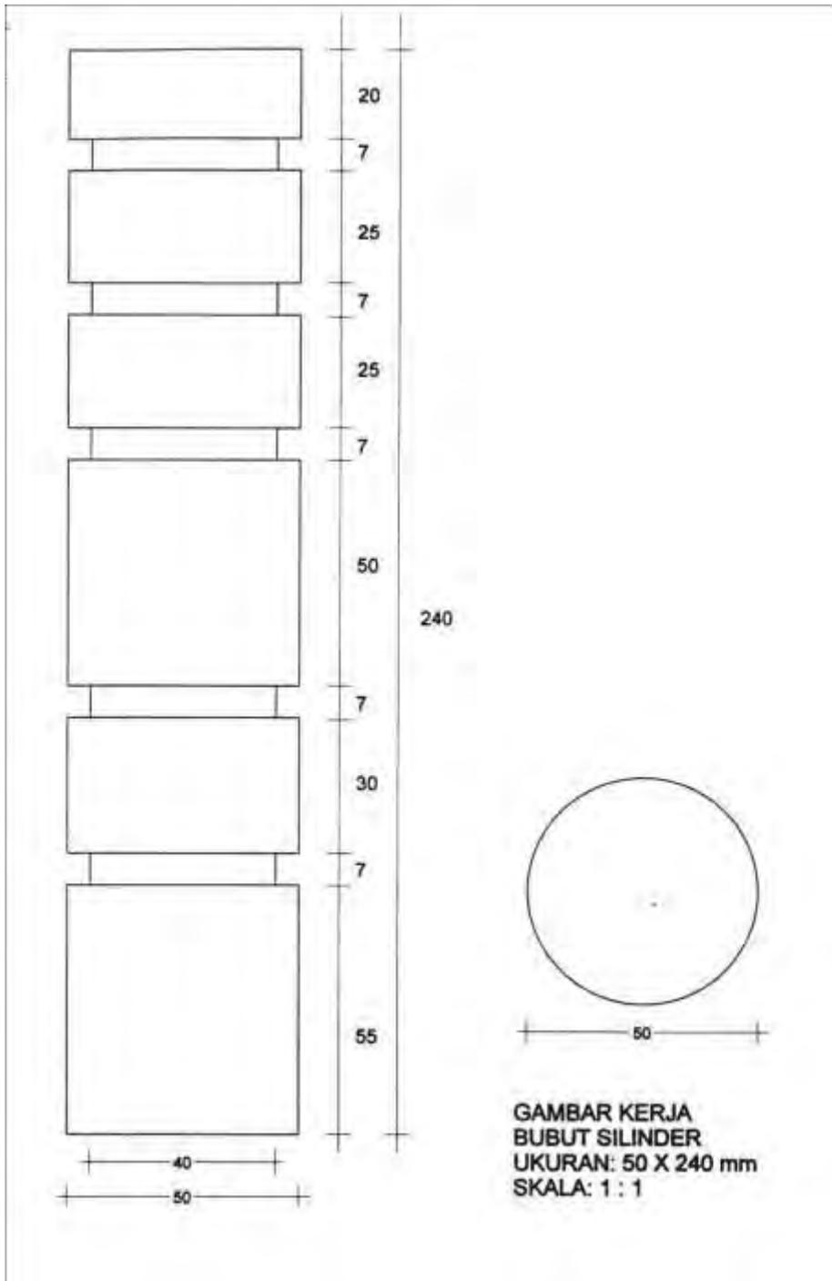
(Gambar 4.16. Gambar kerja profil alur)
