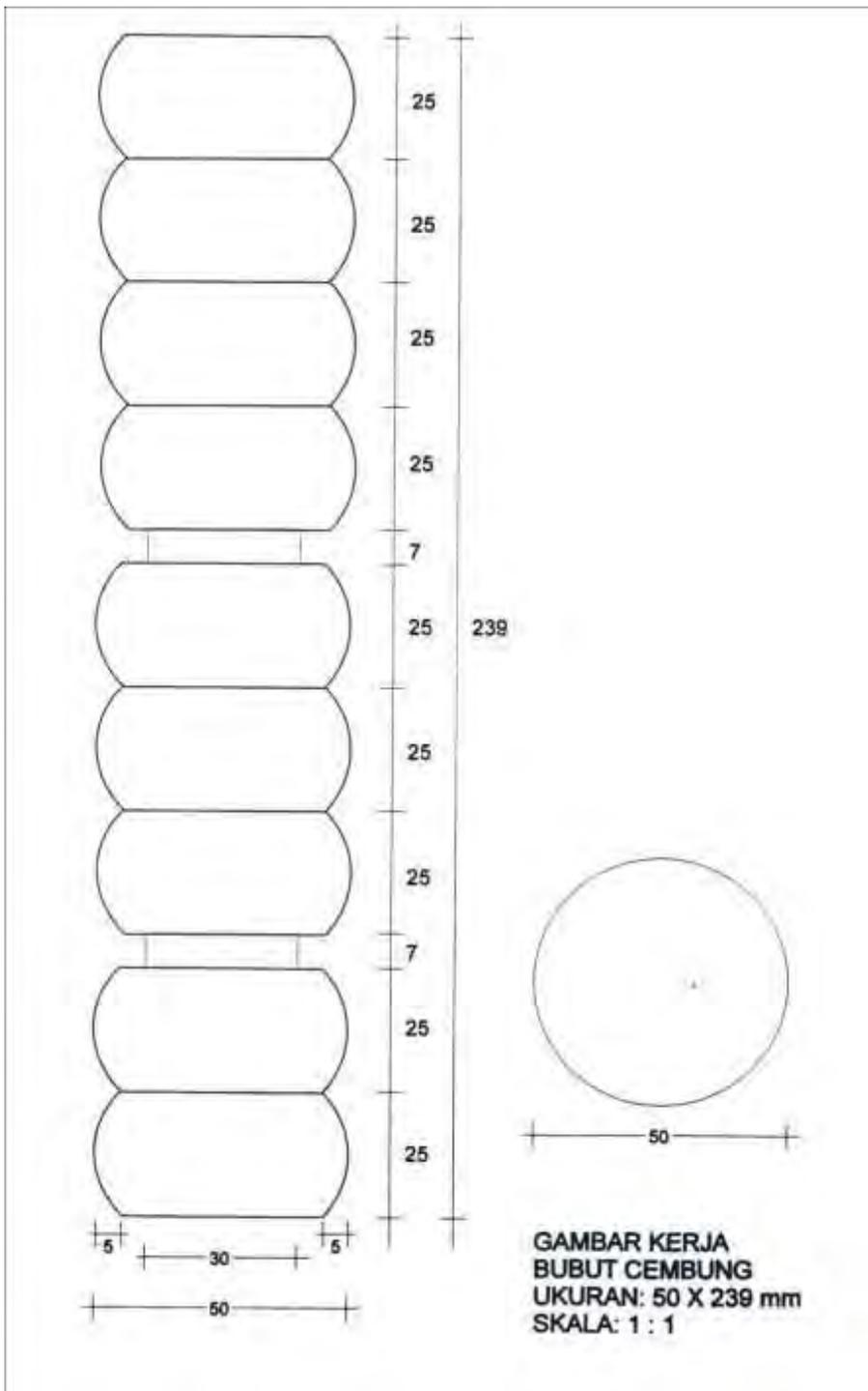
(Gambar 4.15. Gambar kerja profil cembung)
