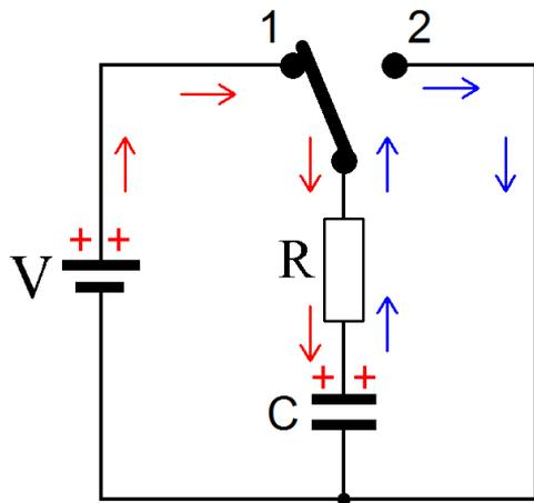
Gambar 5.14. Rangkaian R–C Dengan Sumber Tegangan Searah
