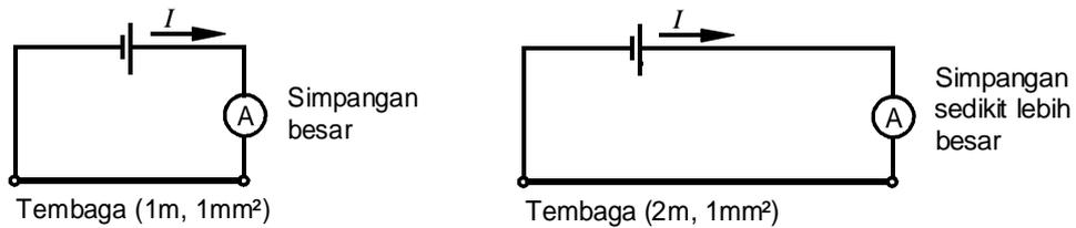
Gambar 3.3 Rangkaian arus dengan panjang penghantar berbeda
