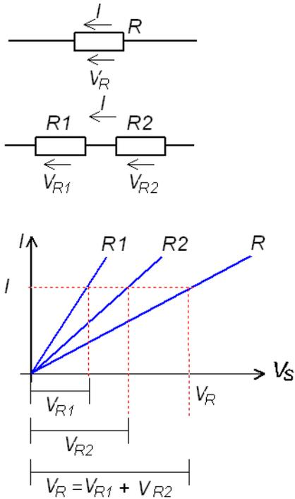
Gambar 2.11. Rangkaian seri dengan 2 buah resistor
