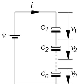
Gambar 5.13. Rangkaian n kapasitor dipasang secara seri
