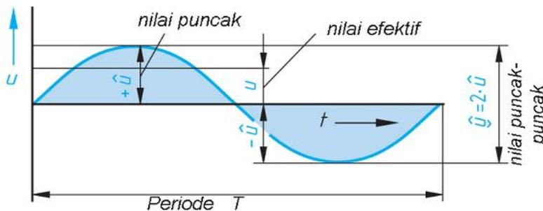
Gambar 3.12 : Nilai puncak, nilai efektif gelombang sinusoida.
