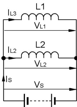
Gambar 1.146 Induktor dalam rangkaian paralel
