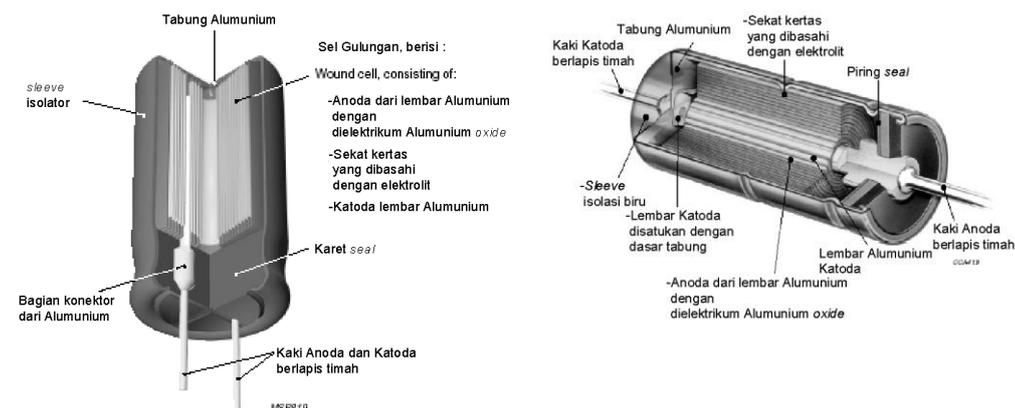
Gambar 5.1. Konstruksi Sebuah Kapasitor
