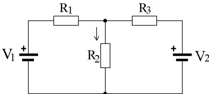
Gambar 4.7 rangkaian resistor dengan 2 sumber tegangan
