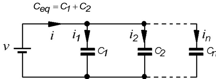
Gambar 5.11. Rangkaian  $n$  kapasitor dipasang secara parallel
