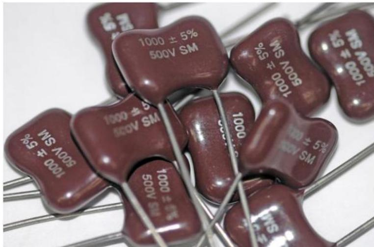
Gambar 5.4. Contoh konstruksi kapasitor Mika
