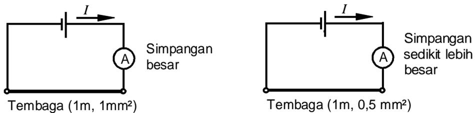
Gambar 3.4 Rangkaian arus dengan luas penampang penghantar berbeda
