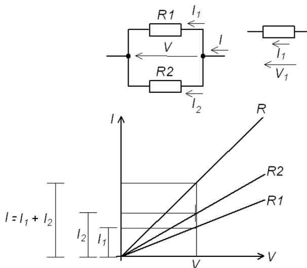
Gambar 2.13. Rangkaian paralel dengan 2 buah resistor
