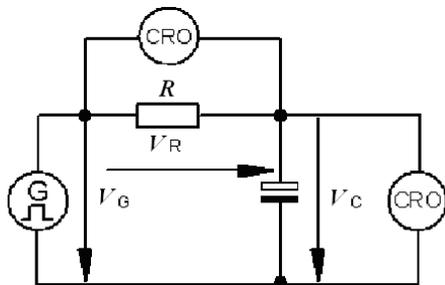
Gambar 5.17. Rangkaian Uji Pengisian dan Pengosongan Kapasitor
