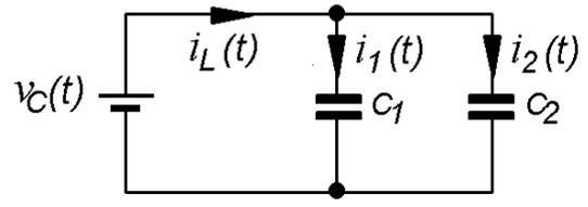
Gambar 5.10. Rangkaian 2 kapasitor dipasang secara paralel
