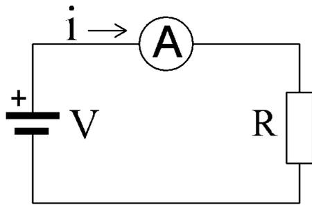
Gambar 4.1 Hubungan arus, tegangan dan hambatan
