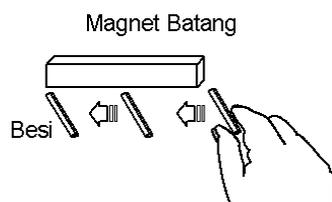
*Gambar 6.2 Percobaan identifikasi kutub magnet*
