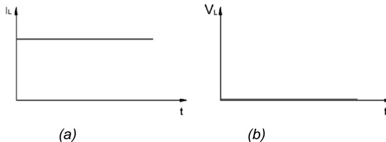
Gambar 1.143 (a) Arus dan (b) Tegangan Induktor
