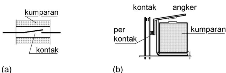
Gambar 1.126 Rele langsung dan tidak langsung
