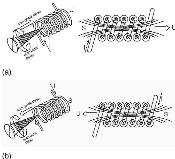
Gambar 1.114 Penentuan kutub pada kumparan yang dialiri arus.
