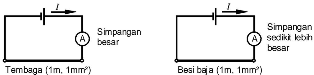
Gambar 3.5 Rangkaian arus dengan bahan penghantar berbeda
