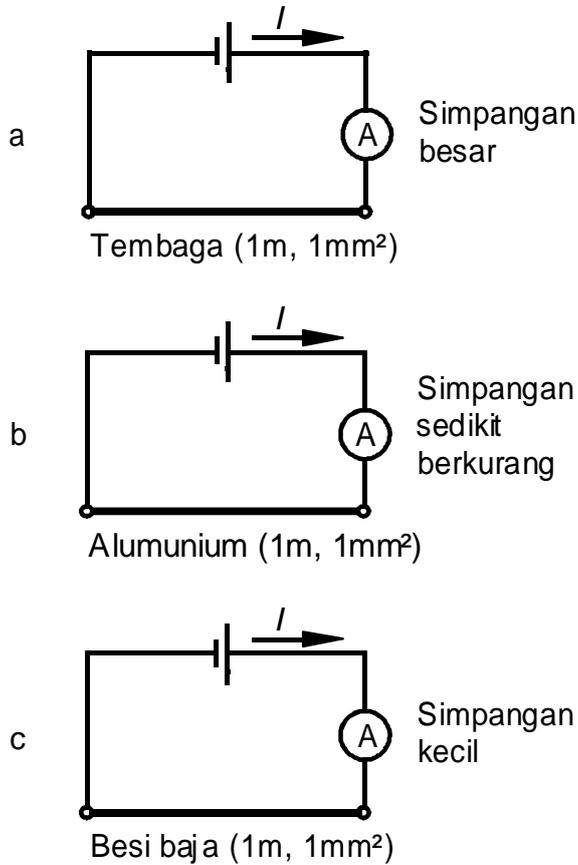
Gambar 3.2 Perbandingan tahanan suatu penghantar: a) Tembaga b) Alumunium dan c) Besi baja
