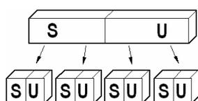
Gambar 6.6 Magnet batang dipotong
