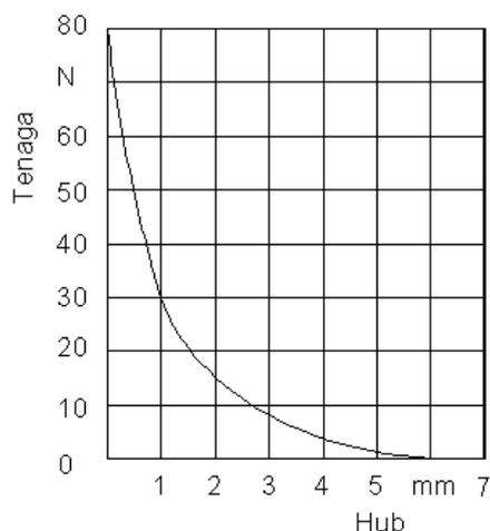
Gambar 1.123. Hubungan tenaga magnet dengan jarak hub
