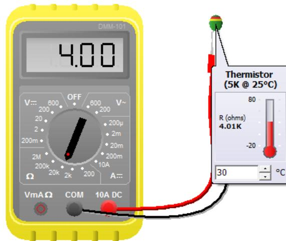
Gambar kerja 1 pengukuran Resistansi NTC terhadap Panas
