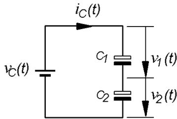
Gambar 5.12. Rangkaian 2 kapasitor dipasang secara seri
