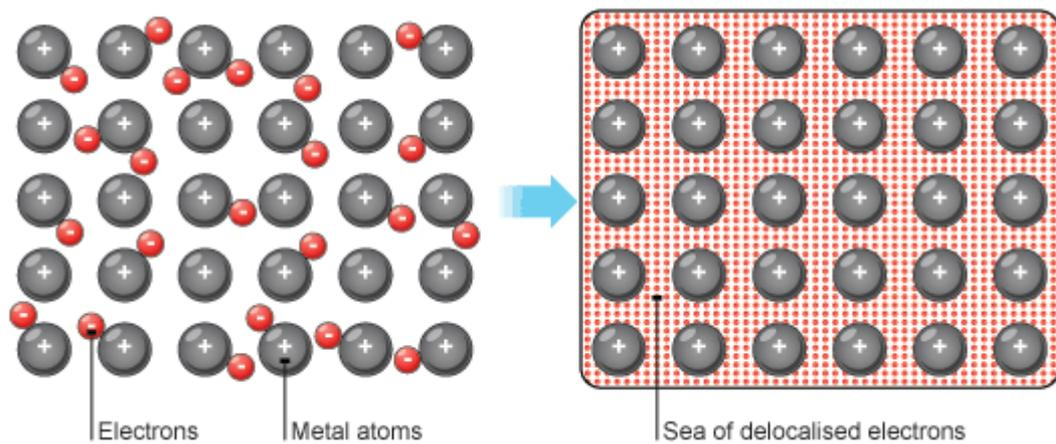
Gambar 1.10 Struktur elektron bebas pada susunan atom konduktor
