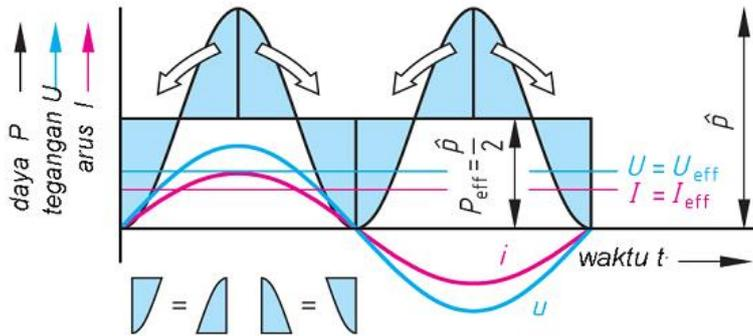
Gambar 3.11 : Prinsip harga efektif gelombang sinusoida
