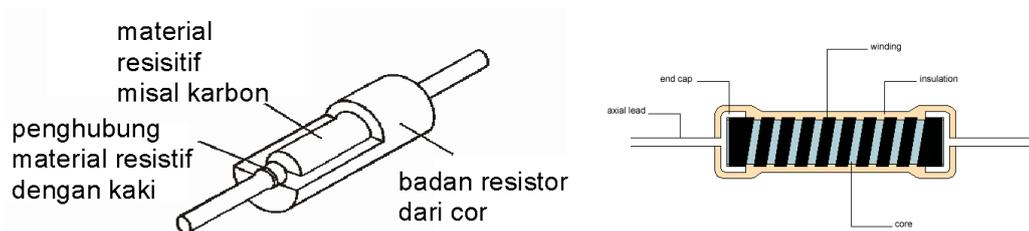
Gambar 3.6. Konstruksi berbagai macam Resistor Tetap
