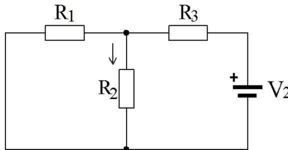
Gambar 4.9 rangkaian ekuivalen, saat  $V1$  dihubung singkat
