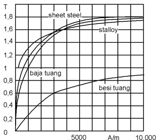
Gambar 1.117 Kurva Kemagnetan
