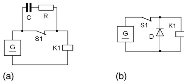
Gambar 1.125 Rangkaian untuk mengatasi gangguan pada Radio
