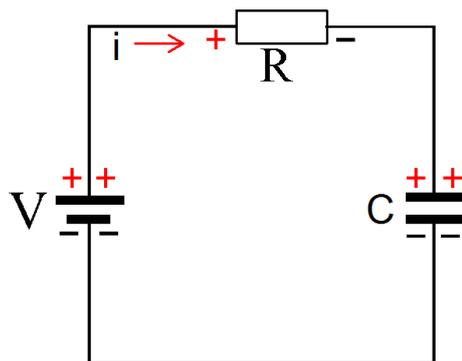
Gambar 5.15. Rangkaian ekuivalen Untuk Menentukan  $V$  dan  $I$  pengisian
