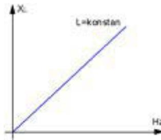
Gambar 12.3 Hubungan reaktansi induktif terhadap frekuensi
