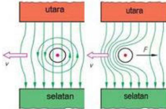
Gambar 2.37 : Interaksi elektromagnetik
