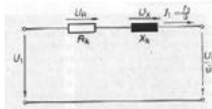
Gambar 11.18 : Rangkaian pengganti Trafo sekunder terhubung singkat
