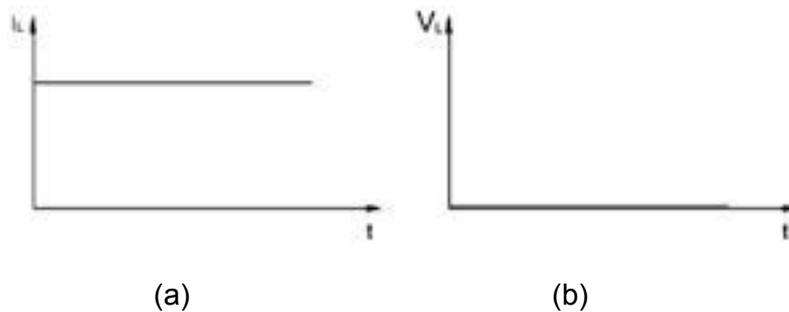
Gambar 9.9 (a) Arus dan (b) Tegangan Induktor
