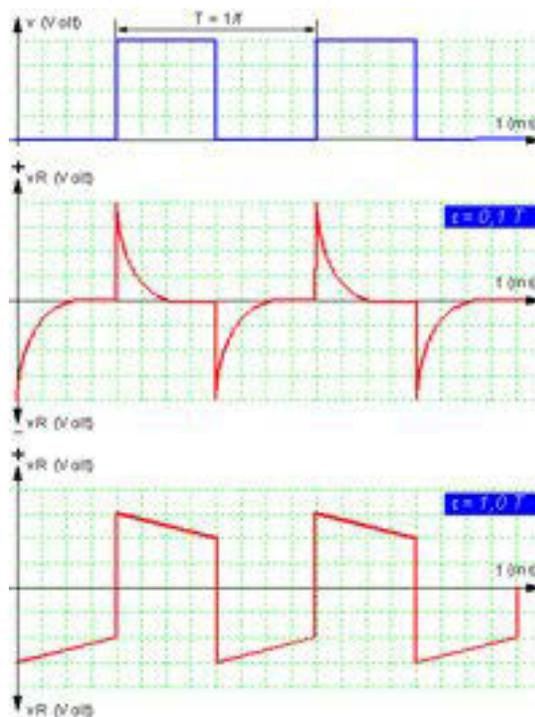
Gambar 12.21 Tegangan keluaran rangkaian diferensiator
