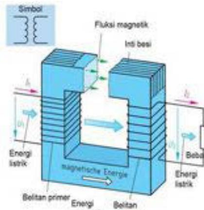
Gambar 11.1 : Prinsip kerja Transformator Satu Fasa
