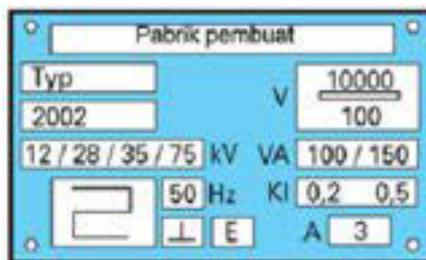
Gambar 11.25 : Keterangan nameplate Trafo Arus
