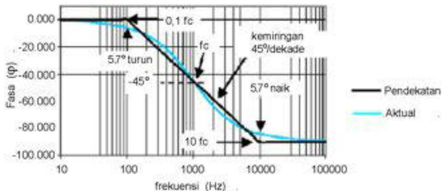
Gambar 12.27 Tanggapan fasa penyaring R-C lurus bawah orde satu
