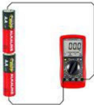
*Gambar hubungan seri 2 buah Baterai*
