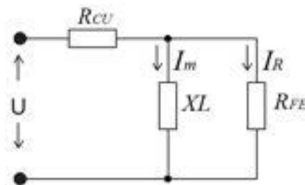
Gambar 4.16 : Rangkaian pengganti Trafo tanpa beban
