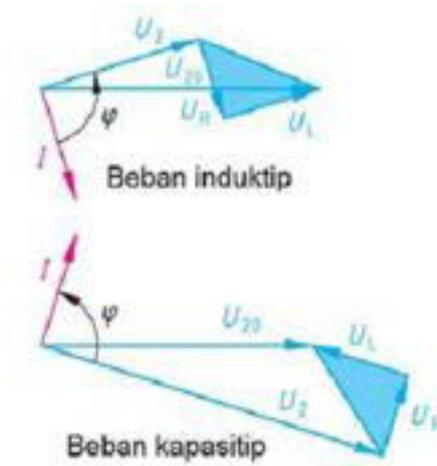
Gambar 11.12 : Vektor tegangan a) beban induktif b) beban kapasitif
