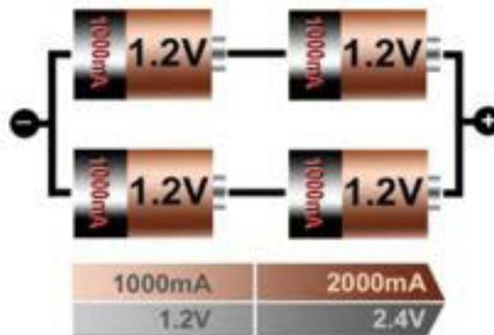
Gambar 10.11 hubungan paralel baterai
