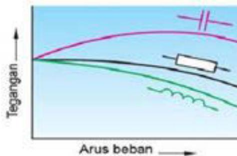
Gambar 11.11 : Grafik tegangan sekunder fungsi arus beban
