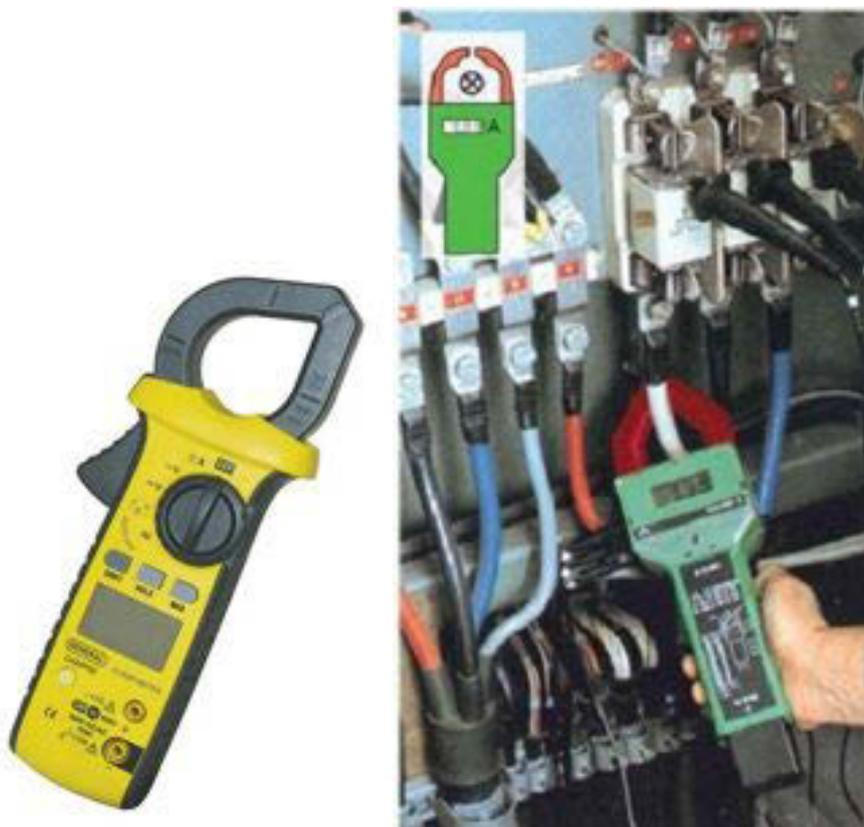
Gambar 11.26 : Aplikasi Trafo arus sebagai meter portable
