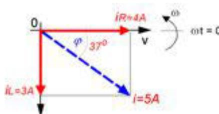
Gambar 2.11 Arus efektif ( $i_R$ ) terhadap arus reaktif ( $i_L$ )
