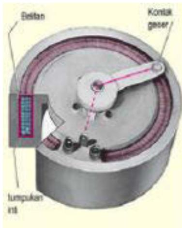
Gambar 11.22 : Autotrafo dengan bentuk inti toroida
