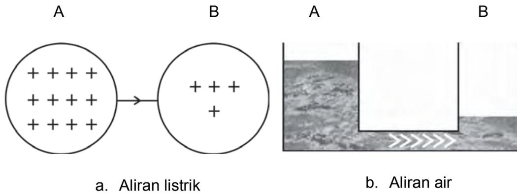
Gambar 1.11 Aliran muatan positif dari A ke B identik dengan aliran air dari A ke B
