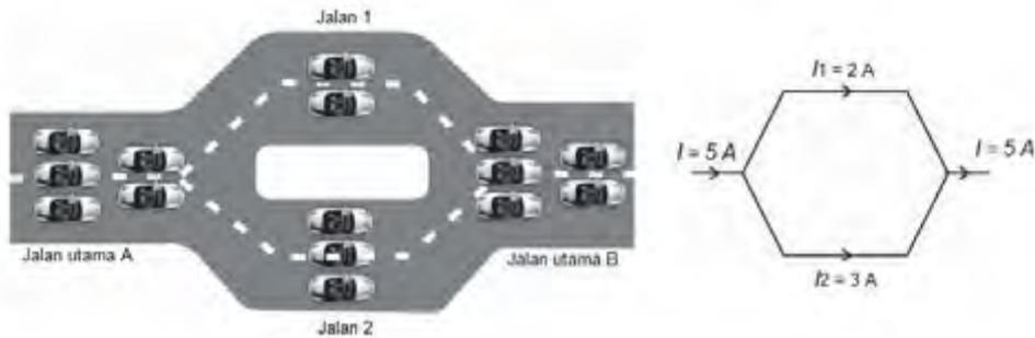
Gambar 2.5 Jumlah arus tiap titik pada rangkaian bercabang
