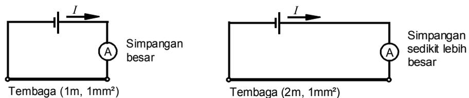
*Gambar 1.29 Rangkaian arus dengan panjang penghantar berbeda*
