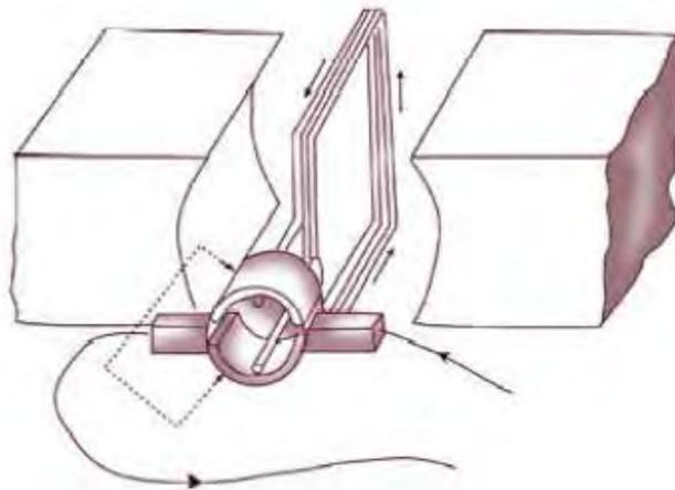
*Gambar 3.20 Cara kerja motor listrik*
