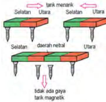
Gambar 3.3 : Daerah netral pada magnet permanet
