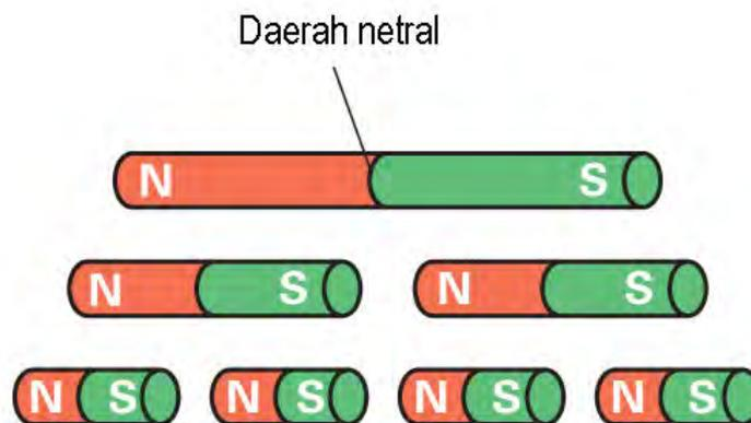
Gambar 3.2 : Kutub utara-selatan magnet permanen
