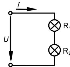
Gambar 4.13 Rangkaian arus dengan suatu tegangan klem
