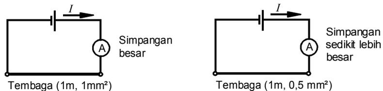
*Gambar 1.29 Rangkaian arus dengan luas penampang penghantar berbeda*
