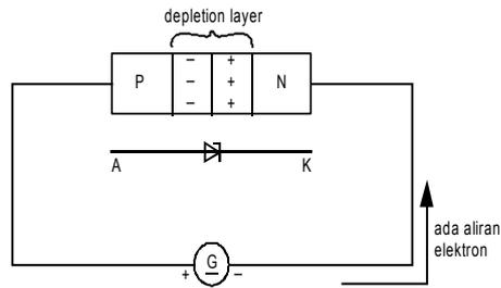
Gambar 7.24 depletion layer pada dioda zener dalam arah forward
