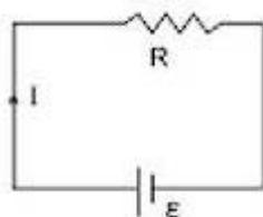
Gambar 2.3 Rangka tertutup sederhana
