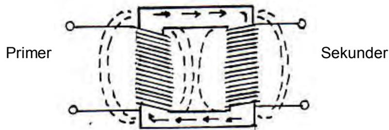
Gambar 6.7 Bagan Trafo yang dilalui Arus Listrik
