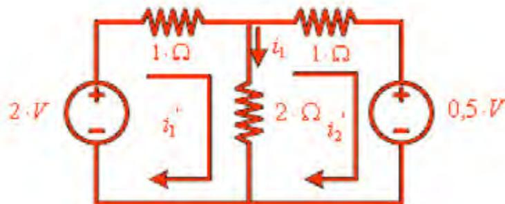
Gambar 2.14 Ilustrasi rangkai teori substitusi
