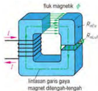
Gambar 3.13 Kerapatan flux magnet
