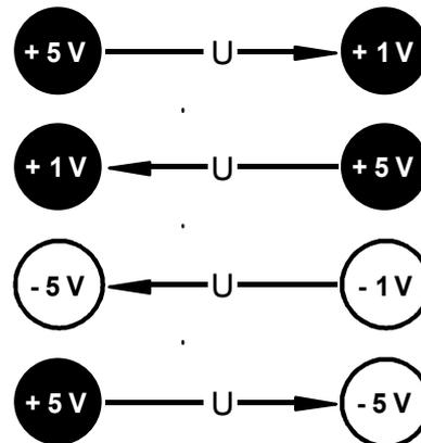
*Gambar 1.19 Anak panah tegangan pada potensial yang diberikan*
