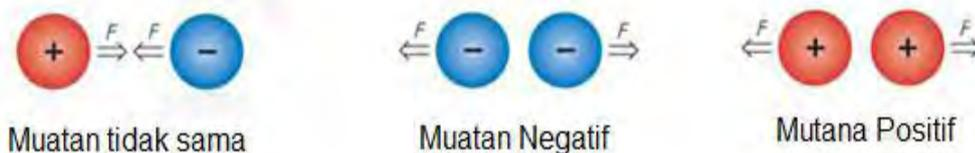
Gambar 1.7 Efek dinamis muatan-muatan listrik
