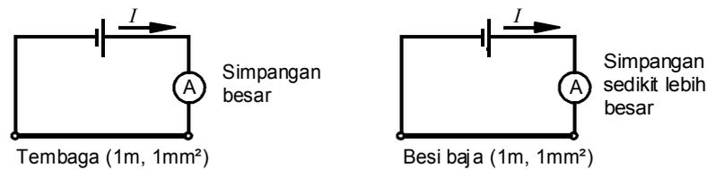
Gambar 1.30 Rangkaian arus dengan bahan penghantar berbeda
