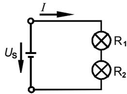
Gambar 4.12 Rangkaian arus dengan sebuah sumber tegangan
