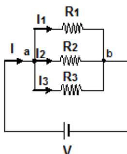
Gambar 2.4 Rangkaian Hambatan Paralel
