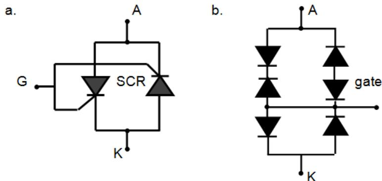
Gambar 10.3 konstruksi Triac
