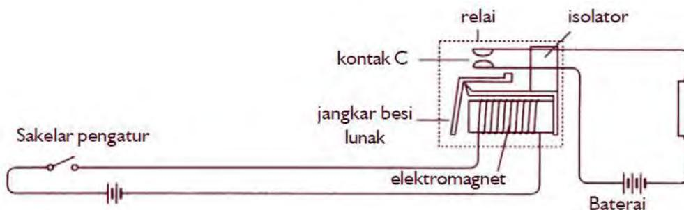
*Gambar 3.25 Relai magnetik pada motor listrik*
