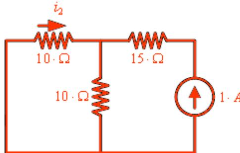
Gambar 2.11 Rangkaian dengan sumber di hubung singkat
