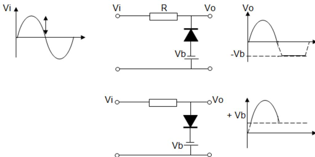
Gambar 7.16 Rangkaian Clipper Paralel Negatif
