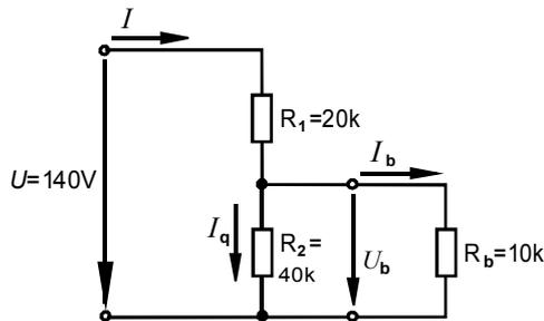
Gambar 4.11 Pembagi tegangan berbeban
