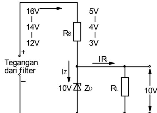
Gambar 7.27 Penstabil tegangan pada output penyearah
