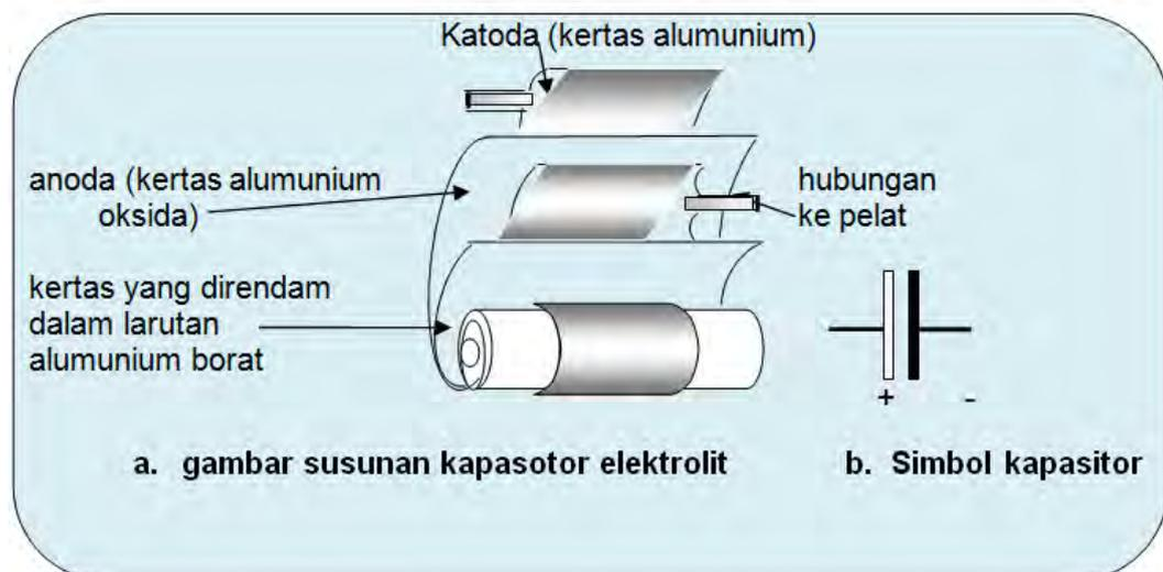
a. gambar susunan kapasitor elektrolit
