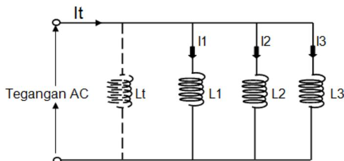
Gambar 6.5 induktor hubung paralel
