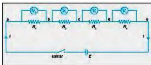
Gambar 2.3 Rangkaian Seri Resistor
