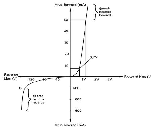
**Gambar 7.6 Kurva karakteristik dioda**
