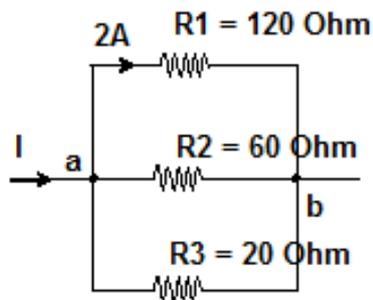
Perhatikan rangkaian hambatan paralel pada Gambar disamping.
