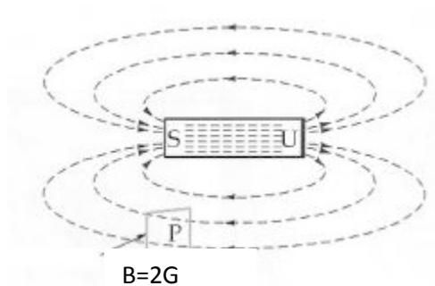
Gambar 3. 12 Kepadatan flux *B* pada titik *P* adalah 2 garis per centimeter persegi atau 2 G
