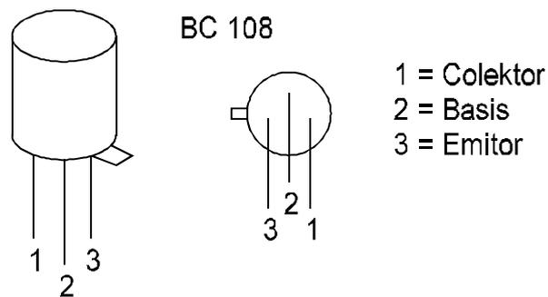
Gambar 8.4 Bentuk Transistor
