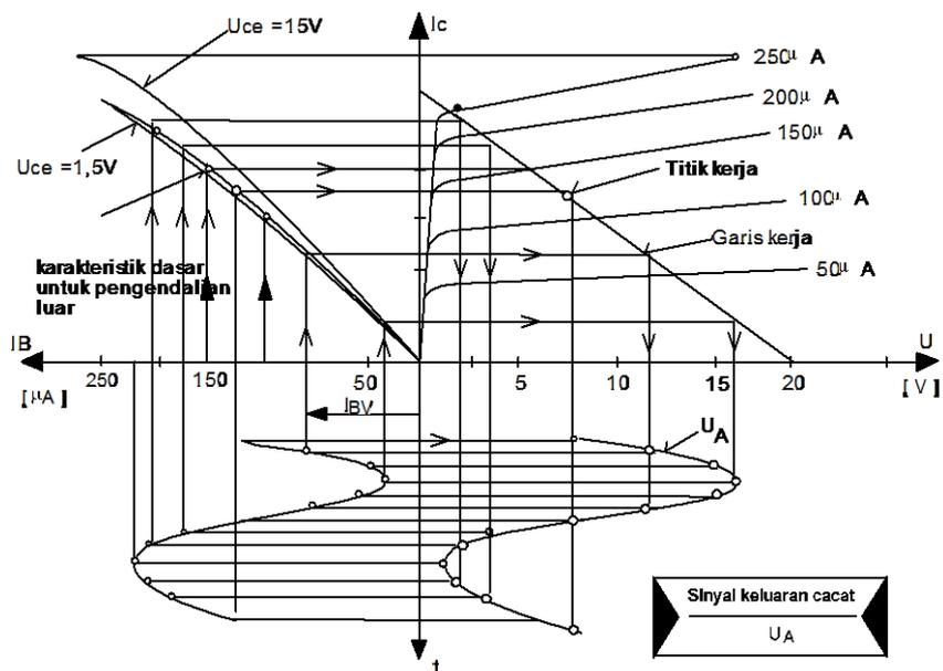
Gambar 8.11 Posisi Titik Kerja - Operasi Penguat
