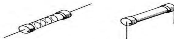
Gambar 4.2 Hambatan Karbon yang diupkan Aksial dan Radial
