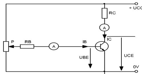
2. Hubungkan rangkaian yang sudah dibuat dengan tegangan 12 Volt DC.
