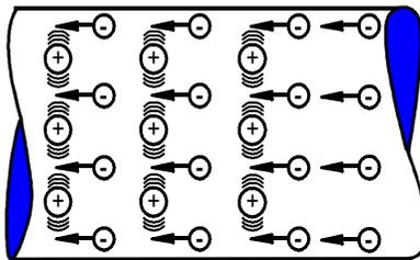
Gambar 4.1 Tahanan pada penghantar logam yang dipanaskan
