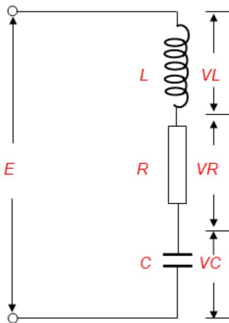
Frekuensi resonansi terjadi pada rangkaian R-L-C yang diberi tegangan AC, dan resonansi terjadi pada saat  $X_L = X_C$ , impedansi ( $Z$ ) sama dengan  $R$ .
