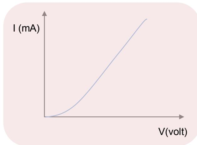
Gambar 4.19 Karakteristik Arus -Tegangan sebuah VDR.
