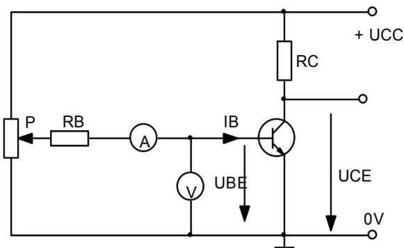
Gambar 8.6 rangkaian untuk mengetahui karakteristik input transistor
