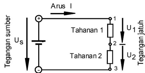
*Gambar 1.18 Tegangan sumber dan tegangan jatuh pada suatu rangkaian*
