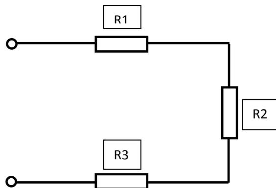
Gambar 4.8 Rangkaian seri resistor
