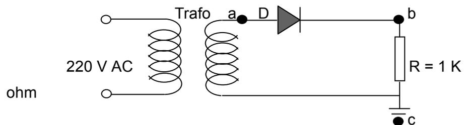
2. Setelah dinilai benar hubungkan dengan sumber tegangan AC 220 Volt.
