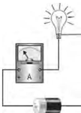
1. Rangkailah sebuah baterai, amperemeter, dan lampu seperti pada gambar di samping dengan menggunakan kabel!
