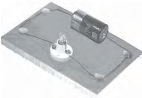
1. Rangkailah bola lampu dan sebuah baterai dengan menggunakan kabel di atas papan kayu seperti pada gambar di samping!
