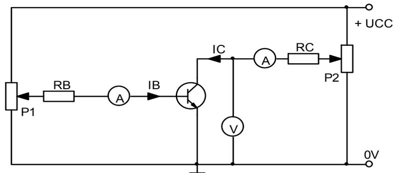
Gambar 8.8 Rangkaian untuk mengetahui karakteristik output transistor
