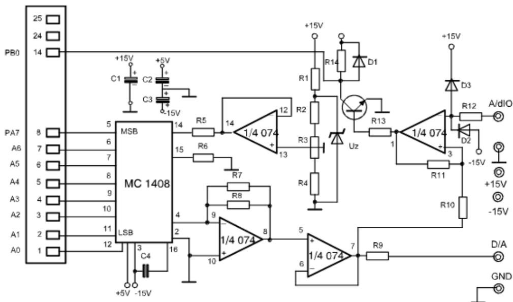
Prinsip kerja rangkaian yaitu memadukan antara keluaran DAC dengan masukan besaran analog melalui rangkaian komparator, selanjutnya hasil komparator dihubungkan dengan port B dari port I/O 8255. Jika hasil komparasi 0 maka hasil komversi analog ke digital selesai dan selama hasil komparasi terbaca pada port B = 1 maka konversi masih harus dilakukan. Dengan memanfaatkan setiap kali
