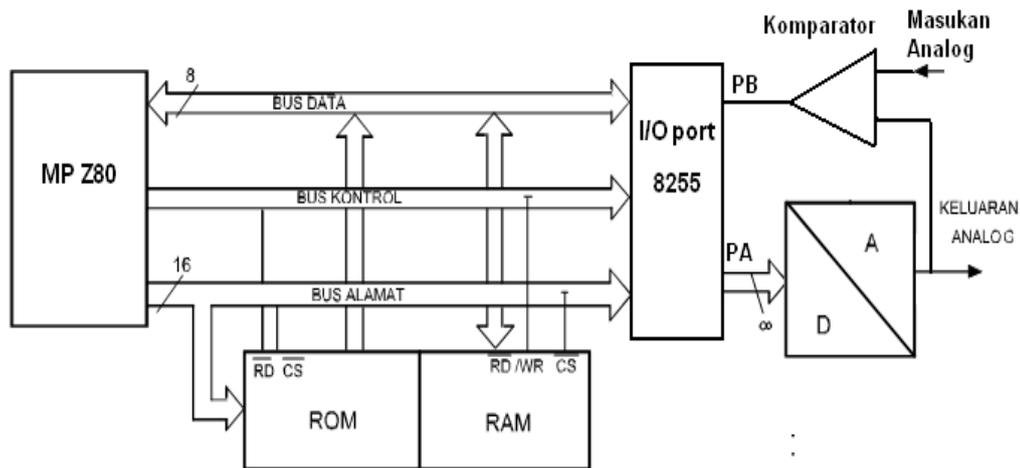
Rancangan ADC ( *Analog Digital Converter* ) pada hakekatnya dibangun dari rangkaian DAC ( *Digital to Analog Converter* ) seperti ditunjukkan pada gambar berikut:
