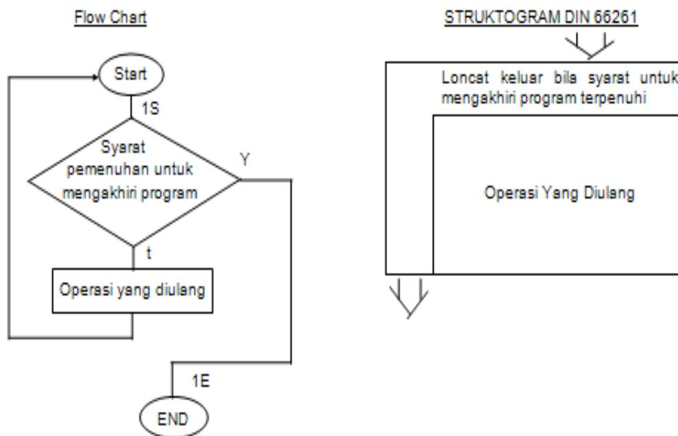
Gambar 5.9. Pengulangan dengan syarat sebelum operasi pada struktogram
