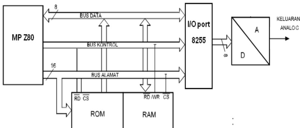
Berikut rangkaian elektronika dari pengalih digital ke analog, rangkaian didukung sebuah *chip* IC MC 1408 yang berfungsi sebagai DAC, dan rangkaian tegangan referensi yaitu melalui tegangan UZ diperoleh tegangan referensi yang stabil sehingga konversi sangat baik serta rangkaian penyangga beban untuk keluaran analog (op-amp 074).
