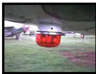
**Gambar 7.12 (Anti Collision pada posisi lampu di atas)**
