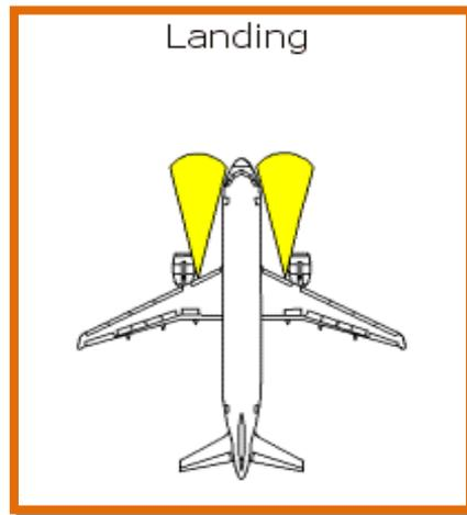
**Gambar 7.6 (Posisi lampu Landing Light di pesawat)**
