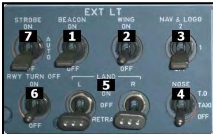
**Gambar 7.7 (Selektor Kontrol Lampu Pendaratan)**
