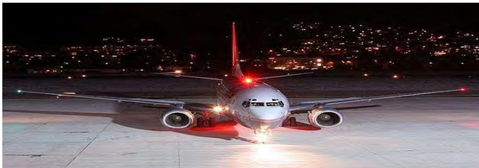
**Gambar 7.11 (Anti Collision pada posisi lampu di atas)**
