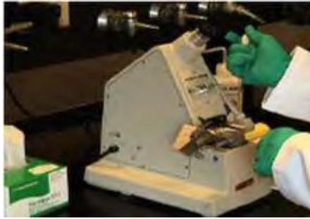
3. Pakai pipet untuk mengambil cairan ke prisma.
