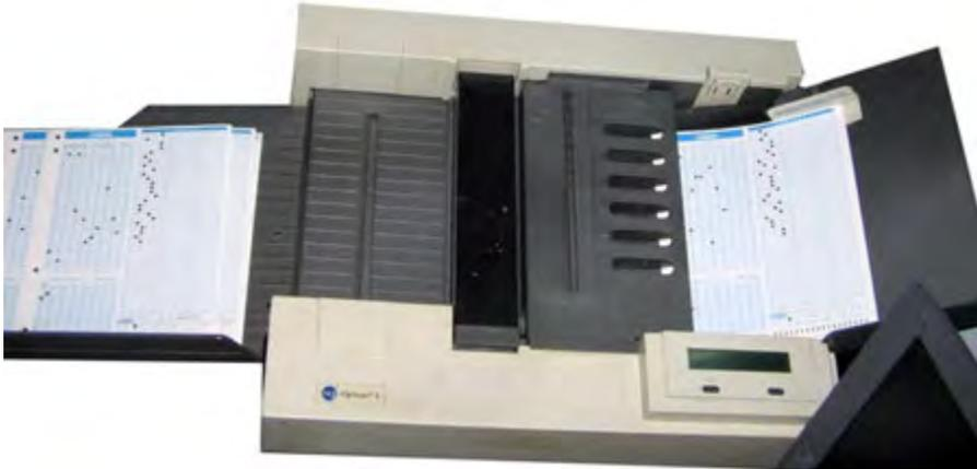
**Gambar 4.3** *Scanner Automatic Document Feeder* untuk menkoreksi LJK
