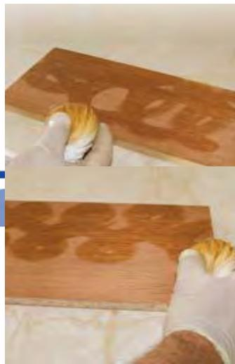
*polish* menyusup pada pori – pori dan permukaan benda kerja tidak ada lagi pori – pori dan permukaan benda kerja tidak ada lagi pori-pori, karena polisi sudah mengering dengan baik. Untuk mempermudah pekerjaan bodying-up ini biasanya dibantu dengan menggunakan Linseed oil atau sejenisnya untuk memperlancar gerakan gerakan tersebut
