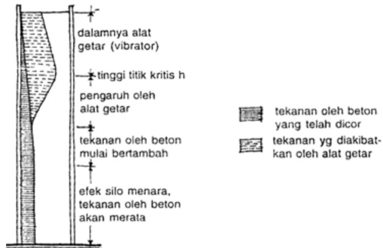
Gambar 90. Tekanan yang timbul dalam konstruksi bekisting beton pada waktu pengecoran
