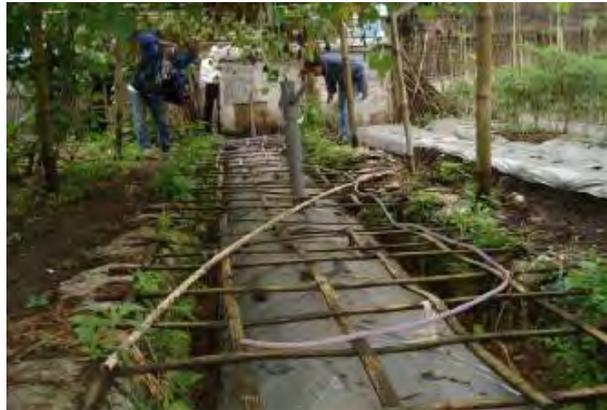
Gambar 28. Reaktor biogas yang terbuat dari plastik
