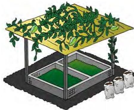
Gambar 11. Pengomposan *bio-slurry* pada lubang penampungan
