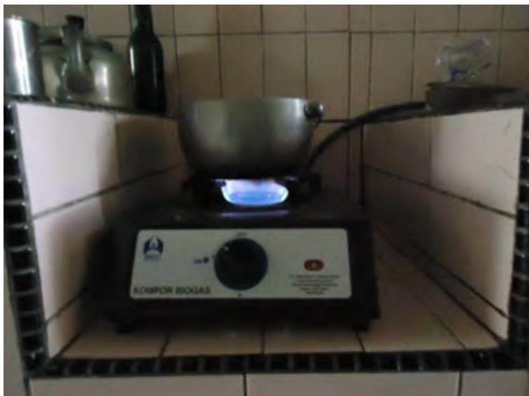
Gambar 169. Kompor biogas
