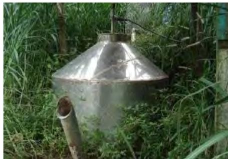
Gambar 31.Reaktor biogas dari lembaran baja
