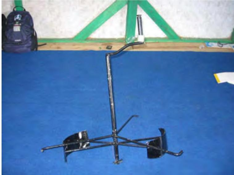
Gambar 123. Mixer untuk mengaduk pada pipa *inlet*
