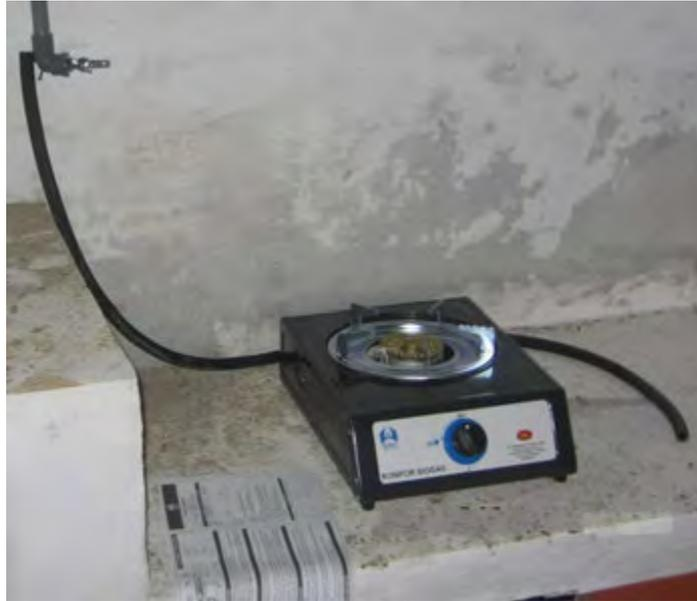
Gambar 157. Contoh kompor biogas
