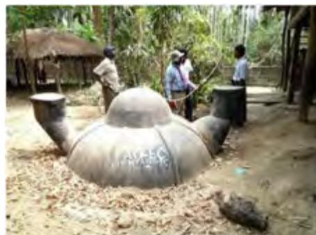
Gambar 32.Reaktor biogas dari besi
