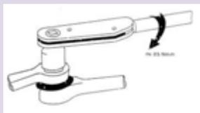
Kencangkan semua ball joint dengan kekencangan 85 Nm. atau menurut buku manual.
