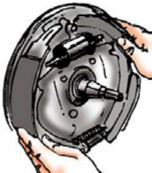
Lepas sepatu rem dengan menarik kedua sepatu rem menjauh dari backing plate.
