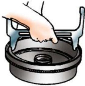
Menggunakan jangka sorong, ukur diameter tromol . Selalu mengukur dari dalam rims . Jika semua pengukuran mikrometer bervariasi kurang dari 010 inci. Berarti tromol konsentris.
