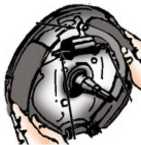
Periksa sepatu rem baru dan tentukan apakah ada perbedaan antara sepatu rem baru dan yang lama, kebanyakan tipe rem servo menggunakan sepatu rem yang berbeda pada setiap roda, lapisan rem satu sepatu lebih panjang dari yang lain.
