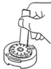
Ukur celah motor dengan ring kanan. Celah maksimum yang diijinkan lihat buku manual. Penggantian ring kam dan rotor harus yang panjang ( bertanda sama ) dan baling-baling harus diganti dengan panjang yang sesuai dengan tanda itu.
