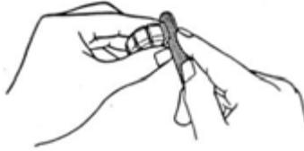
Dengan menggunakan feeler gauge ukur celah antara alur rotor dan pelat baling-baling
