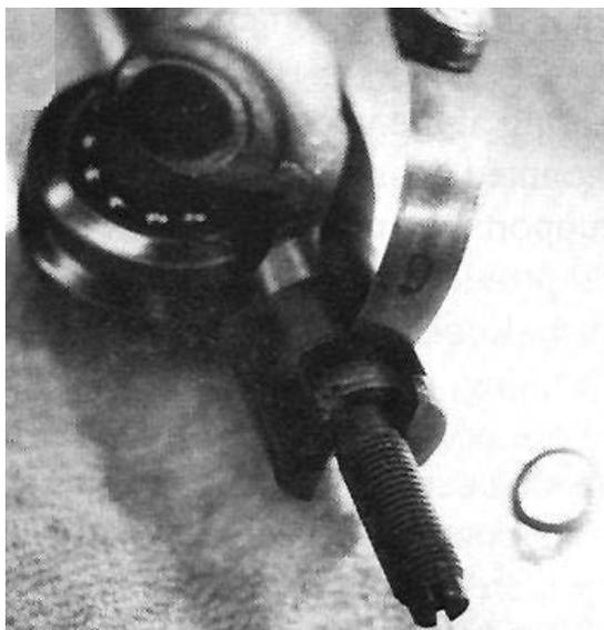
Gambar 199. Poros sktor dengan baut penyetel back-lash.
