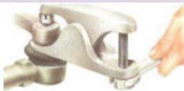
Lepas ball joint dengan traker ball joint atau garpu pelepas ball joint
