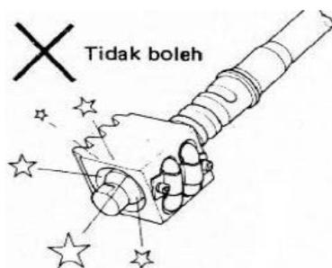
Agar peluru tidak rusak, jangan memukul mur peluru pada ujung worm shaft
