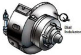
Dengan kendaraan terangkat dan roda pada posisi bebas, pasang dial indikator yang memungkinkan dial indikator untuk menyentuh disk.
