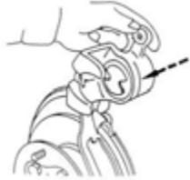
Pasang kaliper pada kerangka dengan cara memasukkan busung kaliper pada batang pengantar tetap. Perhatikan vet dan karet pelindung kotoran !
