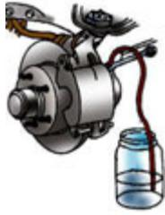
Perhatikan gelembung udara dan tanda-tanda lain dari kontaminasi dalam cairan. Jika sudah tidak ada gelembung udara yang terlihat
