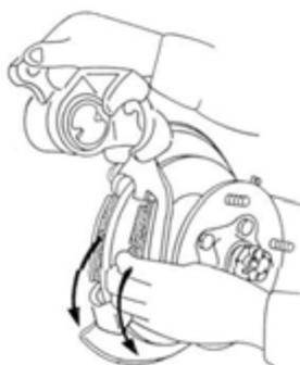
Angkat kaliper dan keluarkan balok – balok rem
