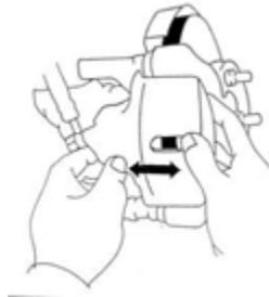
Pasang kaliper pada kerangka, keraskan baut pengikatnya. Kaliper harus dapat bergerak ke kanan dan ke kiri dengan baik. Jika gerakannya berat atau macet, maka busing, batang dan tabung pengantar harus diperbaiki.
