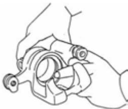
Selama pemasangan, lumasi semua bagian yang bergerak dengan minyak rem bersih atau pelumas lain yang sesuai. Lumasi seal piston, Perlahan-lahan menekan kedalam dengan jari
