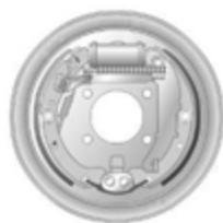
Gambar 32. Self-energizing effect pada sepatu rem primer .
