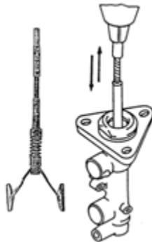
Dihoning dengan alat honing ( menggunakan bor tangan ) Saat menghoning silinder dilumasi dengan air Setelah halus, bersihkan dengan udara kompresor
