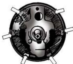
Pemeriksa daerah yang menjadi persinggungan dengan sepatu rem dari tanda-tanda keausan. Selanjutnya melumasi daerah tersebut dengan pelumas yang dirancang untuk menahan suhu tinggi .
