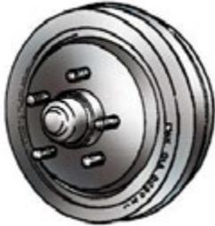
Spesifikasi diameter maksimal tromol tertulis pada bagian luar atau bagian dalam tromol.
