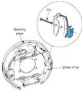
**Gambar 20. Pegas pemegang sepatu rem jenis klip spring.**
