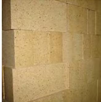
Gambar 16. *Fireclay* untuk membuat bata tahan api.
