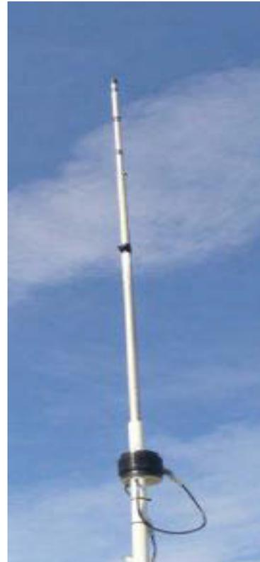
Gambar 8.12. Rancangan antena dan bentuk jadi antena bekerja di 6m band
