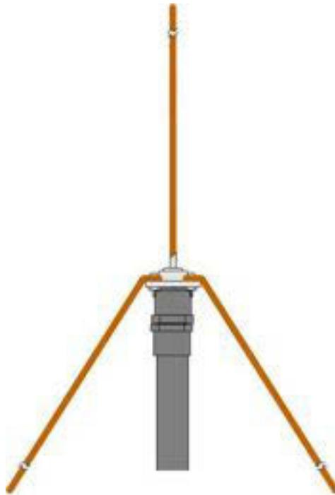
Gambar 7.21. Bentuk akhir antena ground plane vertikal
