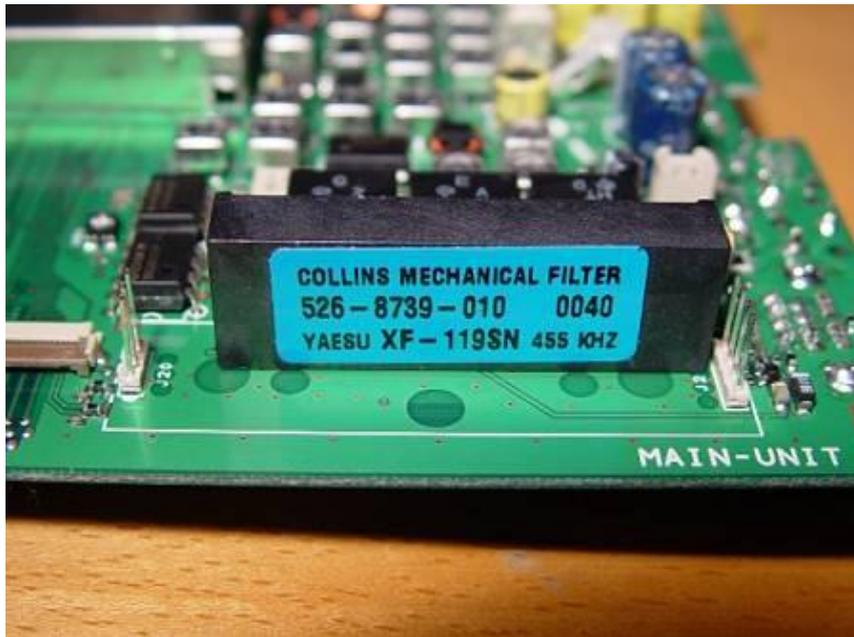
Gambar 7.11. Filter pada perangkat SSB
