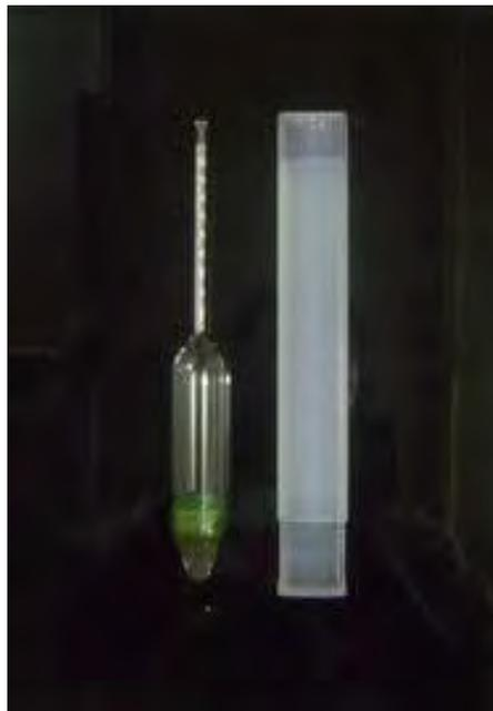
**Gambar 63. metrolac untuk mengukur kadar karet kering**
