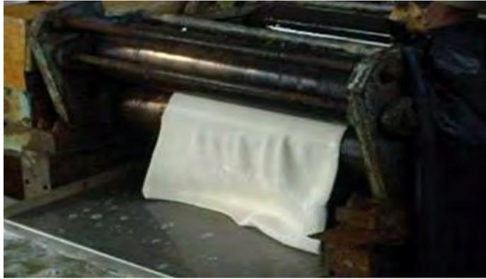
**Gambar 65. Proses penggilingan *sheet***
