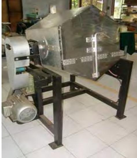
**Gambar 21. Mesin pencampur tipe hexagonal**
