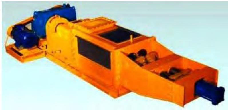
**Gambar 94. Alat pressing digunakan untuk memperoleh minyak kasar ([intisawit.blogspot.com](http://intisawit.blogspot.com))**
