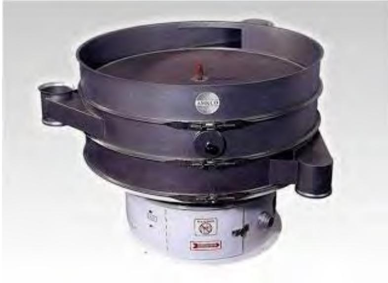
**Gambar 95. *Screening* Getar untuk memisahkan minyak sawit dan kotoran(pt-mitraogan.blogspot.com)**
