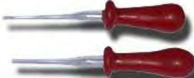
Gambar 25 Pipet alat pengambil air
