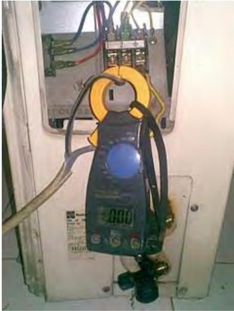
Gambar 4.3 Cara menggunakan tang amper
