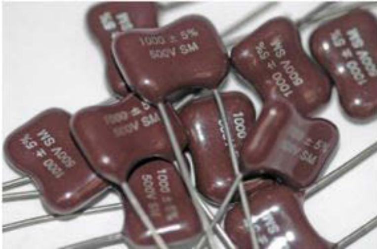
*Gambar 5.4. Contoh konstruksi kapasitor Mika*
