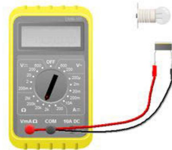
Gambar kerja 2 pengukuran Resistansi LDR terhadap Intensitas cahaya
