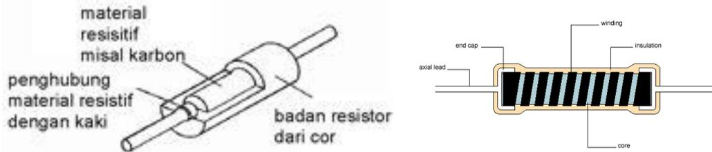
Gambar 3.6. Konstruksi berbagai macam Resistor Tetap
