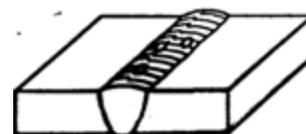
k. **Kurang penetrasi**, yaitu tidak terjadinya perpaduan di antara logam yang disambung yang terdapat pada dasar logam yang disebabkan karena arus pengelasan terlalu rendah, persiapan kampuh yang salah/ *gap* terlalu kecil, *arc length* terlalu jauh, atau karena gerakan elektroda terlalu cepat.
