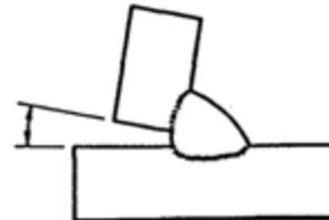
**q. Tidak segaris lurus,** yaitu hasil pengelasan di mana dua bagian yang disambung tidak satu bidang/ level atau seperti paralel. Hal ini terutama disebabkan oleh persiapan yang salah atau distorsi saat pengelasan.
