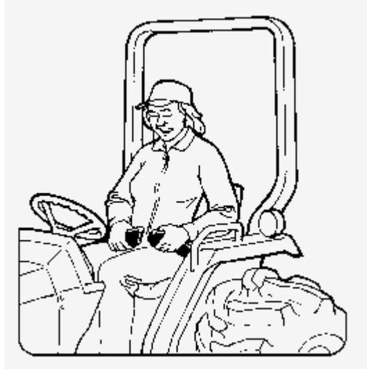
ddd. Menggunakan traktor yang dilengkapi pelindung, serta memasang sabuk pengaman.
