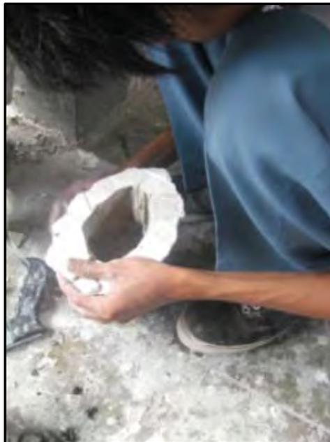
Gambar 102. Cetakan *Mold/Matrix*, Bahan Gips
