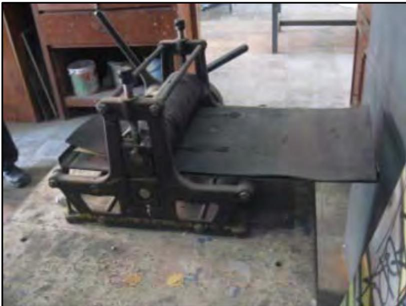
Gambar 116. Alat Press Cetak Bertekanan Tinggi
